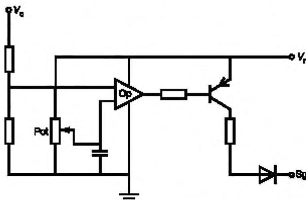
где  $V_c$  — напряжение зарядки;  $V_r$  — сравниваемое напряжение;  $S_g$  — стробирующий импульс;
