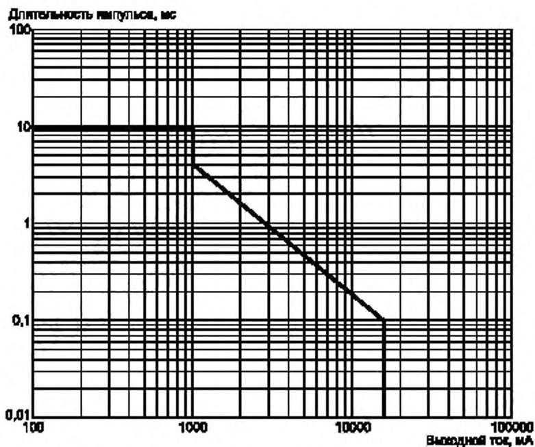
Примечание — Уравнение линии соответствующей длительности импульса (мс) к выходному току (mA) для  $1000 \text{ mA} < \text{выходной ток} < 15700 \text{ mA}$  приводится к длительности импульса =  $41,885 \times 10^{-3} \times (\text{выходной ток})^{-1,34}$ .
