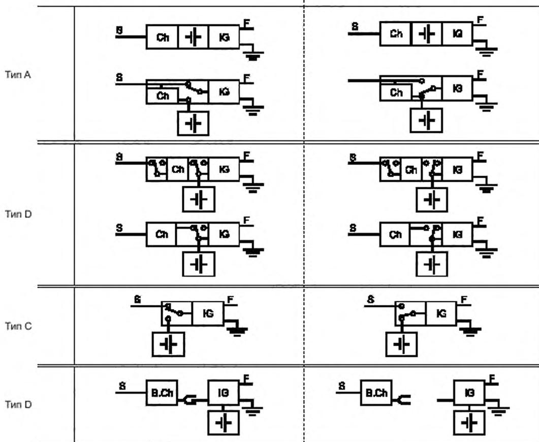
где S — сеть питания; Ch — цепь зарядного устройства батареи, IG — цепь генерирования импульса,
