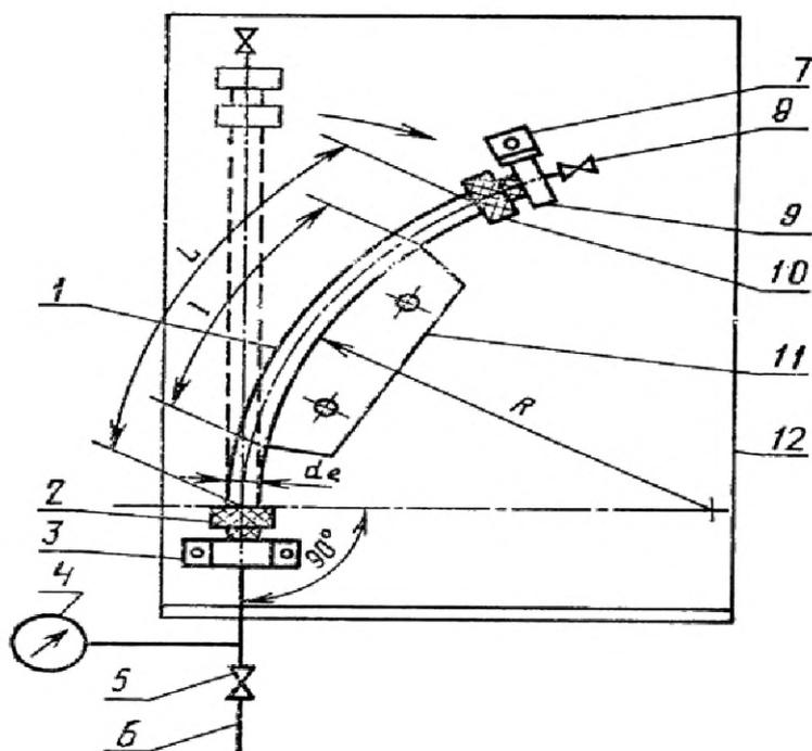
1 – труба; 2 – испытуемое соединение и фитинг; 3 – соединительный ниппель; 4 – манометр; 5 – кран; 6 – источник гидростатического давления; 7 – фиксатор; 8 – воздушный клапан; 9 – концевой ниппель; 10 – фитинг; 11 – шаблон для задания радиуса изгиба; 12 – рама для крепления
