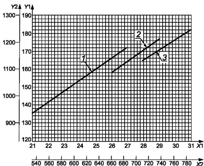
X1 — барометрическое давление, дюймы рт. ст.; X2 — барометрическое давление, мм рт. ст.; Y1 — давление сжатия, избыточное давление в фунтах на квадратный дюйм; Y2 — давление сжатия, кПа
