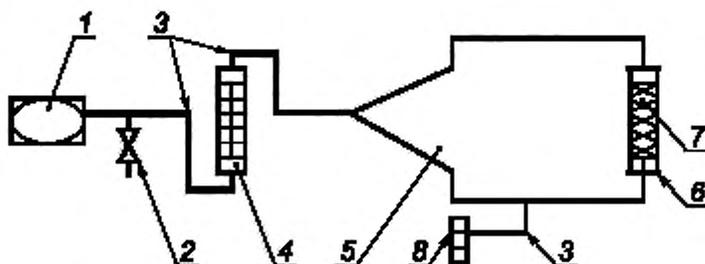
1 — компрессор (воздушный насос); 2 — регулирующая запорная арматура; 3 — шланги; 4 — расходомеры (ротаметры) воздуха; 5 — герметичная камера, обеспечивающая стационарный режим движения воздуха; 6 — приспособление для герметичного крепления образца; 7 — образец; 8 — показывающие или самопишущие манометры, датчики давления
