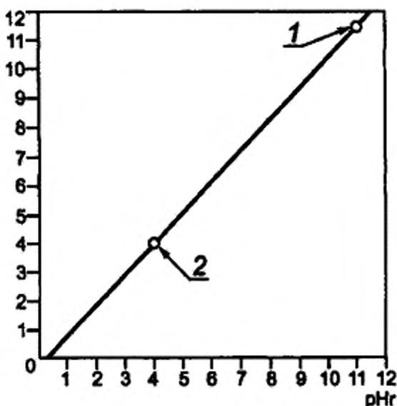
1 — показание прибора в щелочном безводном буферном растворе рН 11,5; 2 — значение прибора, отрегулированное в безводном кислотном буферном растворе рН 4,0
