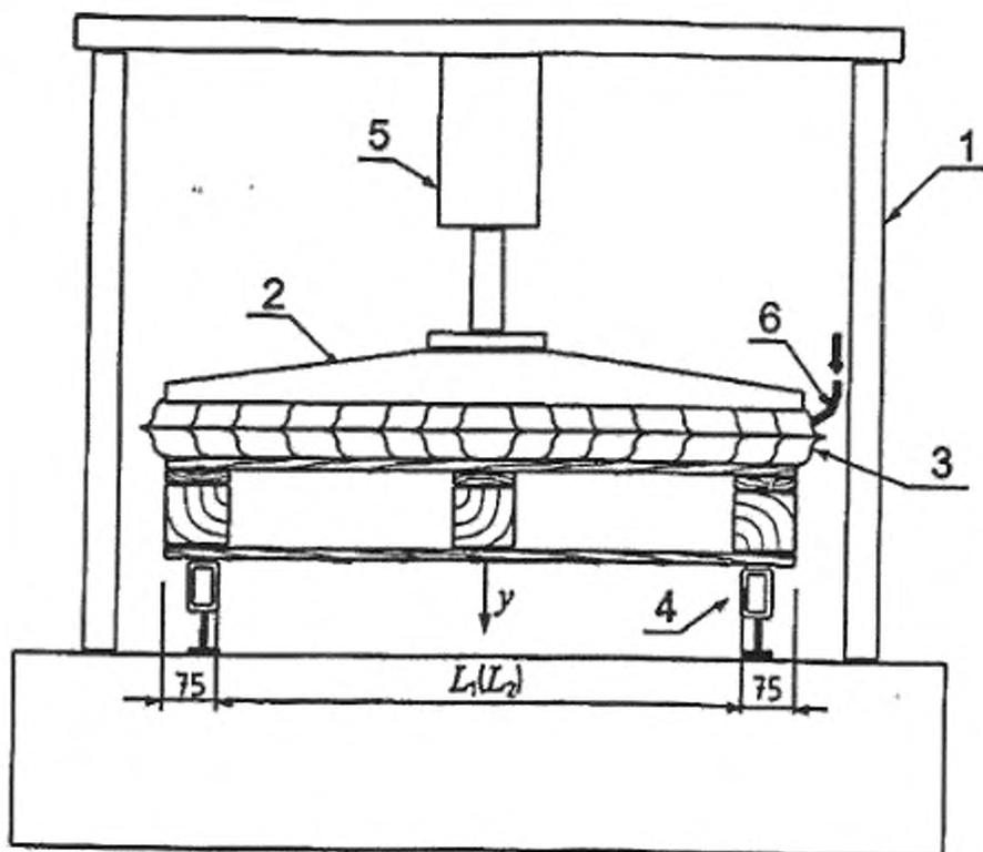
1-рама испытательного стенда, 2- грузовая платформа,
