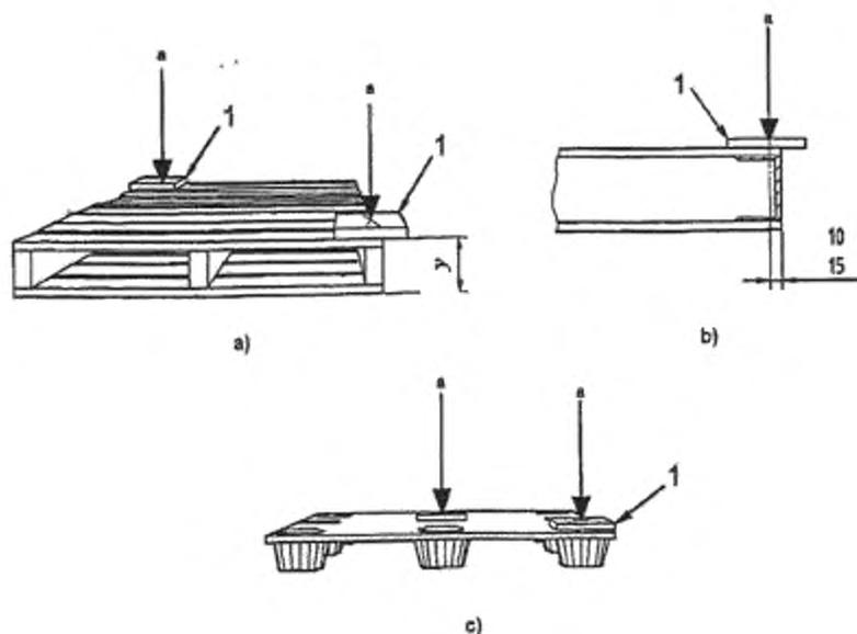
1- аппликатор нагружения, "y" - прогиб, а - испытательная нагрузка
