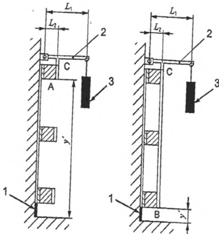
1 - опора, 2- аппликатор нагружения, 3- груз, "y" - прогиб, А- С - точки измерения деформации
