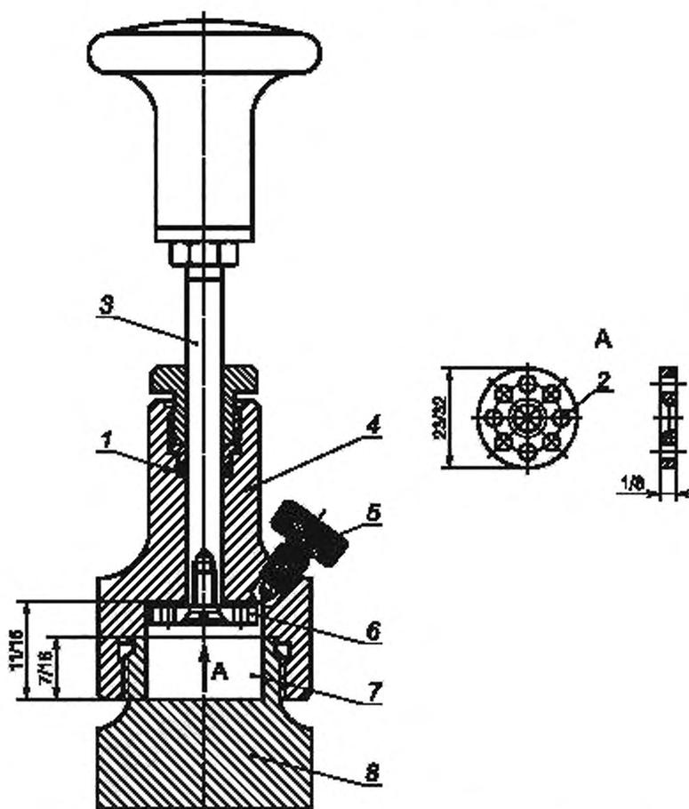
Примечание — Размеры приведены в дюймах. Предельные отклонения размеров, приведенных в дробных числах, составляют  $\pm 1/64$  дюйма ( $\pm 0,4$  мм).
