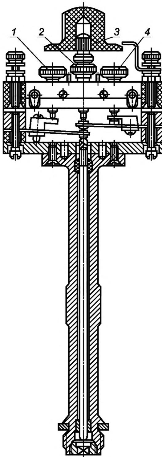
1, 4 — установочные винты; 2 — центральный винт; 3 — регулировочный винт
