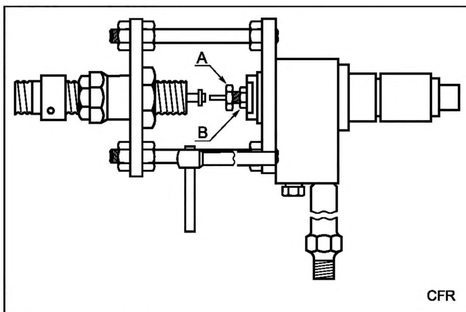
Рисунок Б.1 — Форсунка на стенде проверки форсунок
