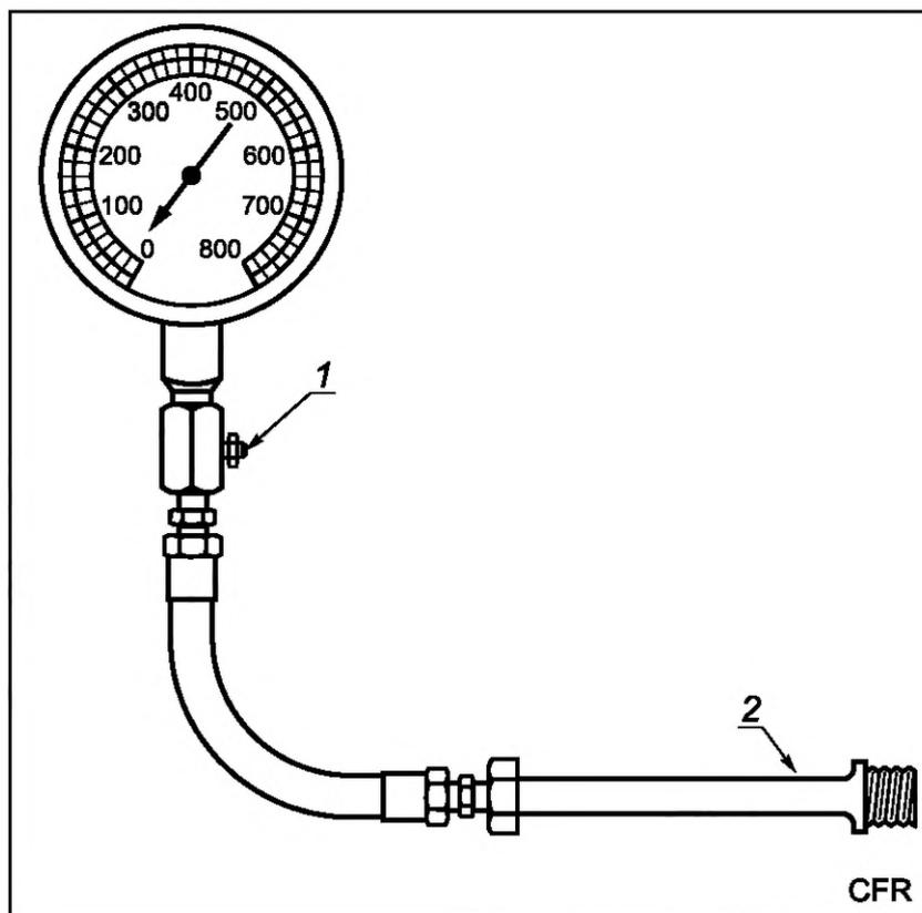
1 — клапан сброса давления; 2 — встроенный обратный клапан
