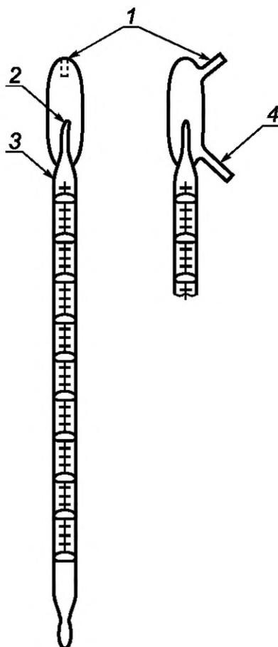
1 — вентиляционная трубка; 2 — автоматический нуль; 3 — градуировка, начинающаяся с 3 %;
