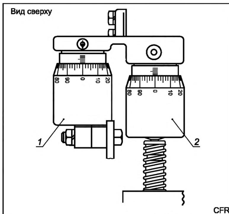
1 — регулировка момента впрыска; 2 — расход топлива
