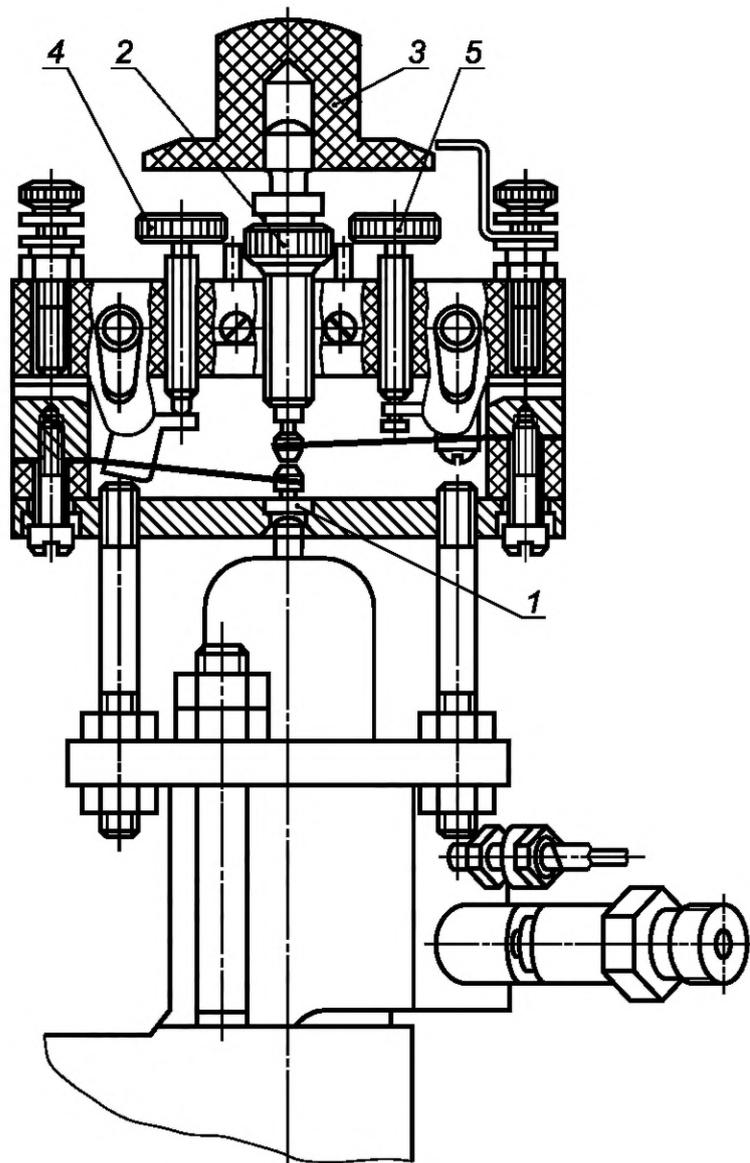
1 — зазор между нижней пластиной и штоком; 2 — центральный винт; 3 — регулировочный винт;
