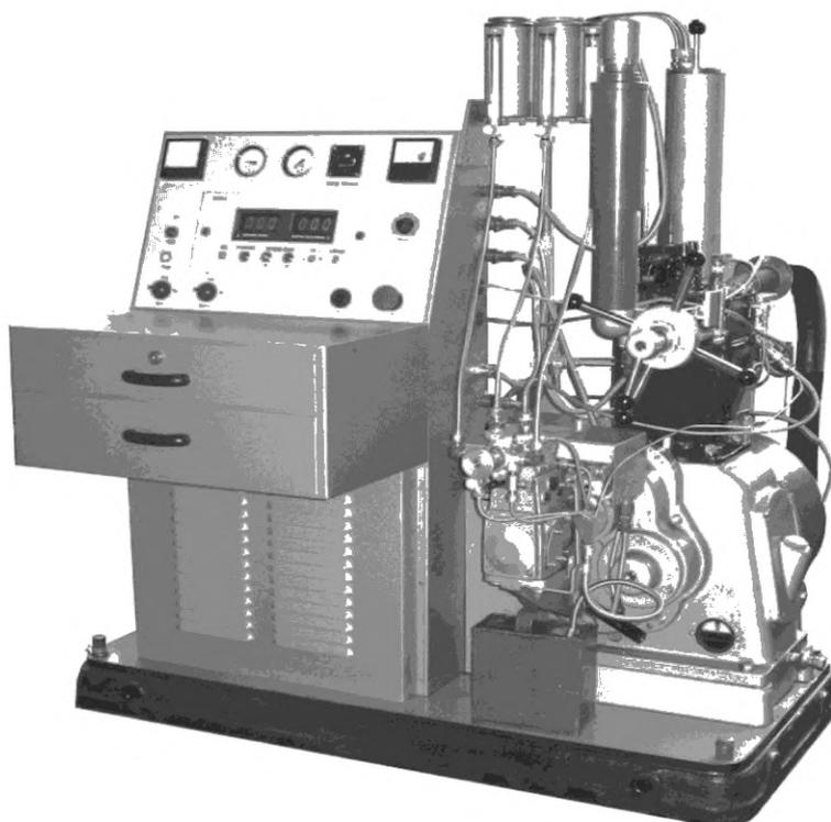
Рисунок 2 — Установка ИДТ-90 для определения цетанового числа
