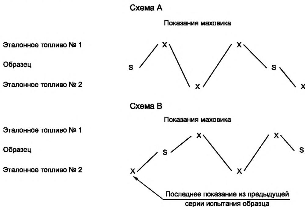
Рисунок 4 — Последовательность снятия показаний образца и эталонных топлив
