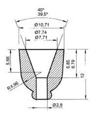
Рисунок 4 — Указатель уровня погружения термометра
