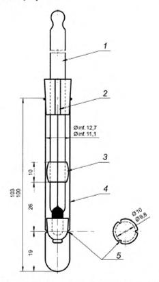
1 — термометр; 2 — прорезь в пробке для выпускного отверстия; 3 — корковая пробка, обеспечивающая при установке зазор с внутренней стенкой пробирки 1,5 мм; 4 — пробирка для испытания из боросиликатного стекла, 5 — три углубления, расположенные на одинаковом расстоянии друг от друга, для удерживания тавотницы
