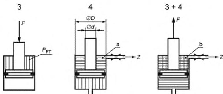
$D$  — диаметр поршня;  $d$  — диаметр штока поршня с цилиндром на растяжение, а блок регулирования скорости действует на кольцевой зазор;  $F$  — нагрузка,  $P$  — давление в системе,  $p_{FT}$  — нормальное давление;  $Z$  — ограниченный расход.
