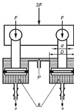
$D$  — диаметр поршня;  $d$  — диаметр штока поршня с цилиндром на растяжение и блоком регулирования скорости, действующим на кольцевой зазор;  $F$  — нагрузка;  $P$  — давление системы;  $p_{FC}$  — нормальное давление;  $Z$  — ограниченный расход.
