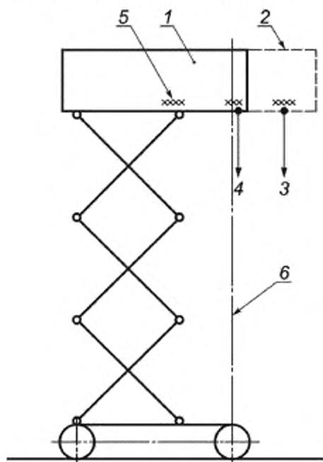
1 — основная рабочая платформа; 2 — удлиненная часть платформы (полностью выдвинутая); 3 — номинальная нагрузка (удлиненная часть платформы),  $m_{p,ext}$ ; 4 — номинальная нагрузка (основная платформа),  $m_{work}$ ; 5 — снятие стабилизирующей части нагрузки на основной рабочей платформе; 6 — линия опрокидывания. Номинальная нагрузка  $m_{ext}$  определяется выражением (см. также 4.2.1):
