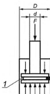
$D$  — диаметр поршня,  $d$  — диаметр штока поршня с цилиндром на растяжение и блоком регулирования скорости действующим на кольцевой зазор.  $F$  — нагрузка; 1 — поврежденное уплотнение
