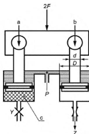
$D$  — диаметр поршня;  $d$  — диаметр штока поршня с цилиндром на растяжение и блоком регулирования скорости, действующим на кольцевой зазор;  $F_B$  — нагрузка продольного изгиба;  $F$  — нагрузка;  $P$  — давление системы;  $p_{FC}$  — нормальное давление под действием нагрузки;  $Z$  — ограниченный расход;  $y$  — заблокированная линия;
