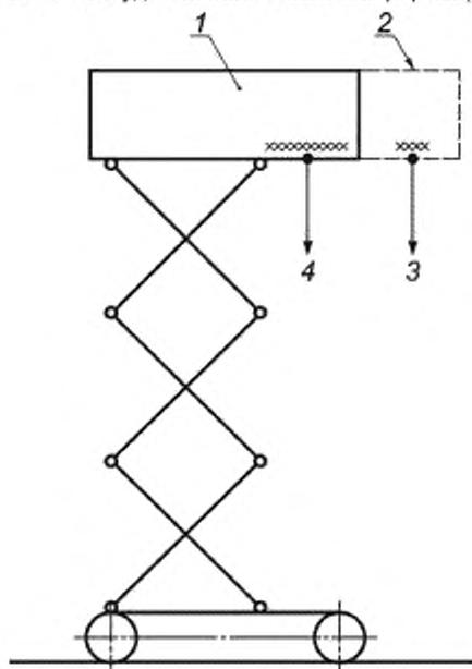
1 — основная рабочая платформа; 2 — удлиненная часть платформы (полностью выдвинутая), 3 — номинальная нагрузка (на удлиненной части платформы),  $m_{ext}$ ; 4 — номинальная нагрузка (на основной платформе),  $m_{work}$ .
