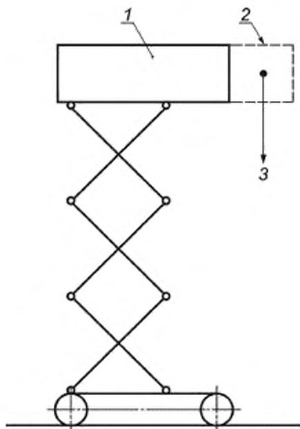
1 — основная рабочая платформа; 2 — платформа удлинения (полностью выдвинутое положение); 3 — номинальная нагрузка,  $m$
