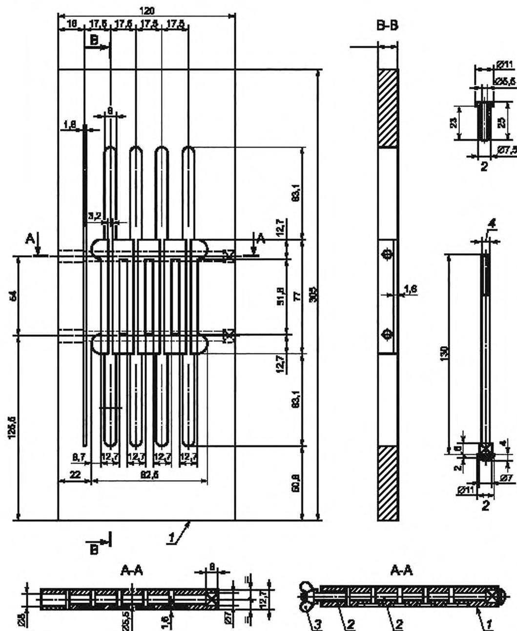
Рисунок X1.2 — Зажимное приспособление для нескольких пластинок
