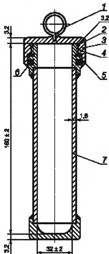
1 — подъемная петля; 2 — широкий паз для сброса давления; 3 — завинчивающаяся крышка; 4 — резьба NF — 12 витков на 1 дюйм или аналогичная; 5 — углубление внутри головки для защиты уплотнительного кольца круглого сечения при закрывании сосуда высокого давления; 6 — уплотнительное резиновое кольцо круглого сечения, не содержащее свободную серу; 7 — цилиндрический сосуд из нержавеющей стали (сварная конструкция, максимальное избыточное давление — 700 кПа)
