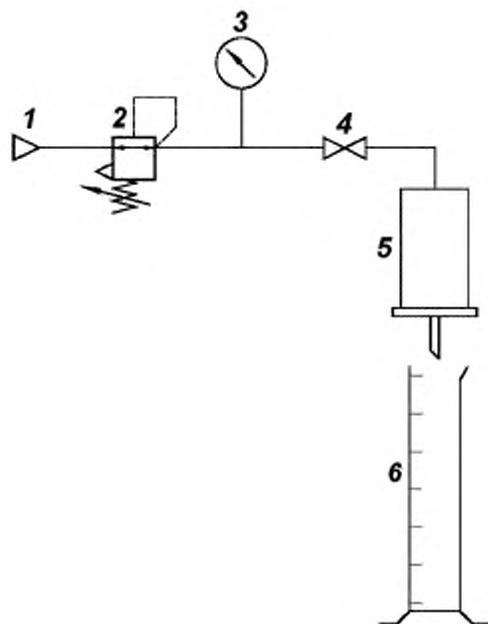
1 — источник сжатого воздуха или азота; 2 — регулятор давления; 3 — манометр; 4 — шаровый клапан; 5 — сосуд высокого давления с опорой для фильтра; 6 — мерный цилиндр
