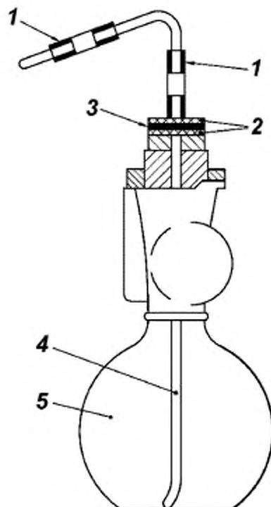
1 — устойчивая к воздействию реактивов пластмассовая трубка; 2 — сито с инертной опорой; 3 — мембранный фильтр с размером пор 0,45 мкм; 4 — устойчивая к воздействию реактивов пластмассовая трубка; 5 — дозатор фильтрующего растворителя
