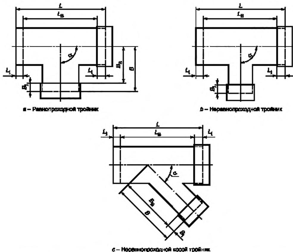
$\alpha$  — установочный угол;  $B$  — длина укладки тройника;  $B_B$  — длина деформации тройника;  $B_3$  — глубина входа раструба тройника;  $L$  — длина укладки главного трубопровода;  $L_B$  — длина корпуса главного трубопровода;  $L_1$  — глубина входа раструба главного трубопровода
