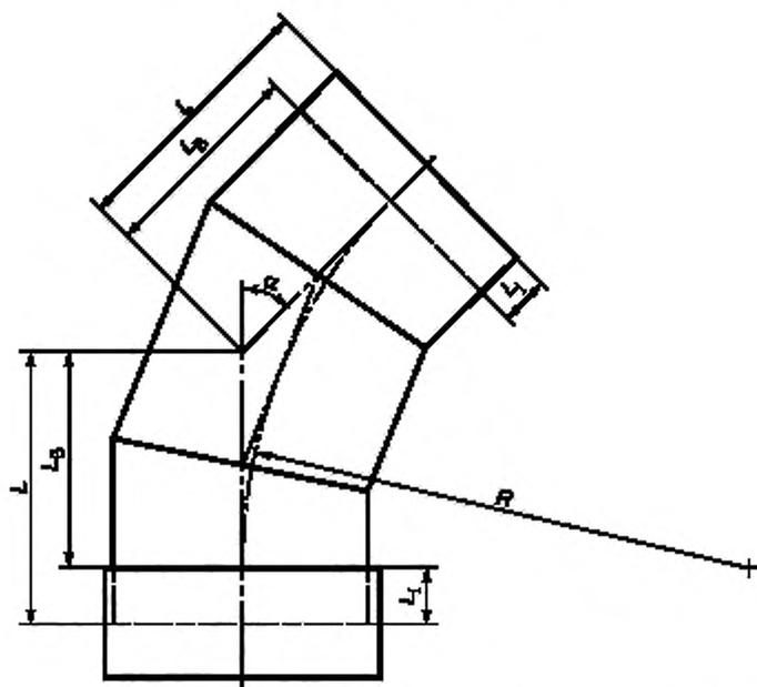
$L_B$  — длина корпуса;  $L$  — длина укладки;  $L_1$  — глубина входа;  $\alpha$  — установочный угол;  $R$  — радиус кривизны
