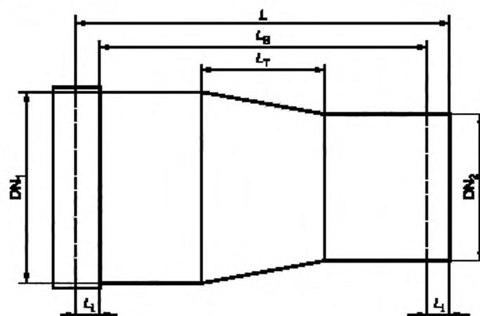
**а** — Переходник с концентричным расположением концевых отверстий
