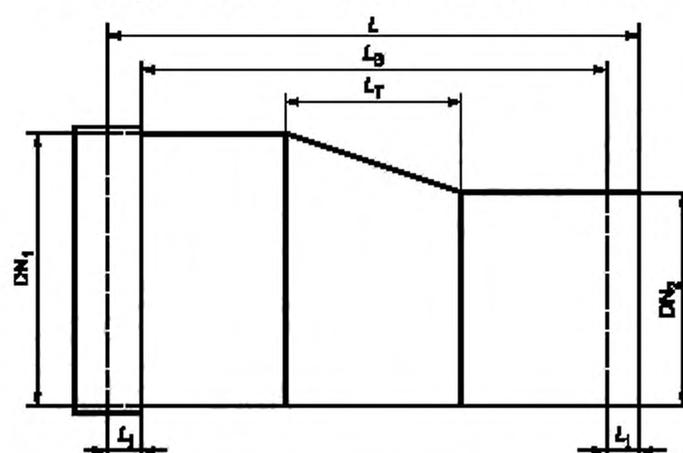
**б** — Переходник с эксцентричным расположением концевых отверстий
