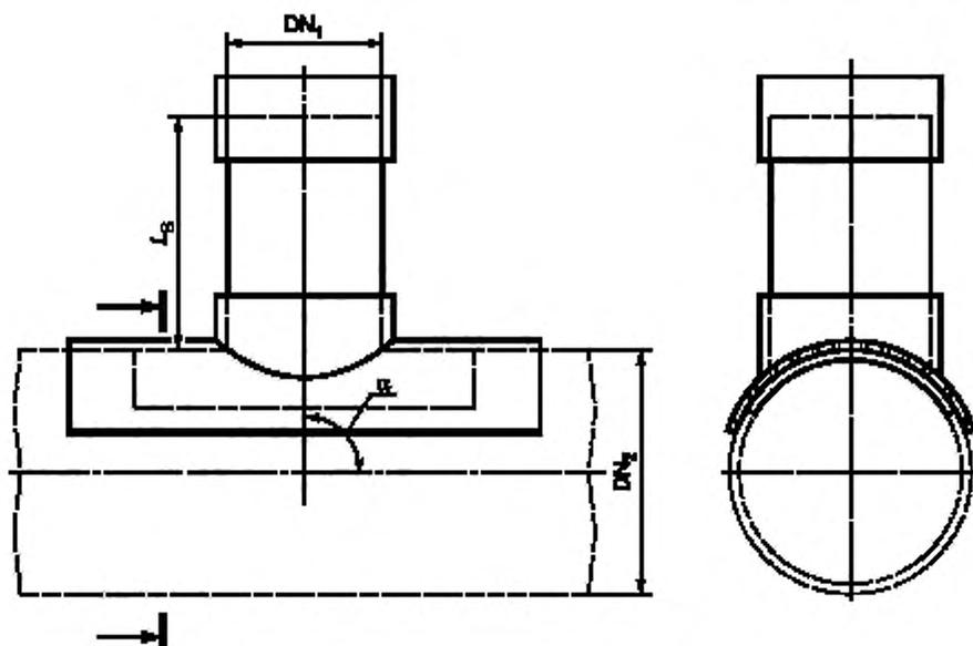
DN<sub>1</sub> — номинальный диаметр отводной трубы; DN<sub>2</sub> — номинальный диаметр главной трубы; L<sub>Б</sub> — длина отводной трубы;
