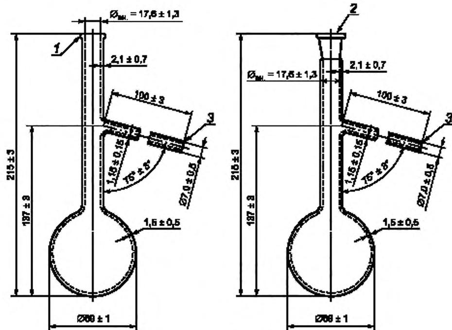
1 — усиливающий буртик; 2 — конус 19/22 или 19/26; 3 — оплавленный край
