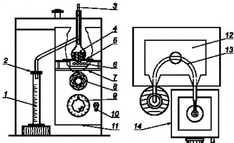
1 — приемный цилиндр; 2 — фильтровальная бумага; 3 — термометр; 4 — перегонная колба; 5 — термостойкая прокладка для установки колбы; 6 — электрический нагревательный элемент; 7 — опора для установки колбы; 8 — круглая ручка для установки колбы; 9 — шкала регулирования нагрева; 10 — выключатель; 11 — открытый снизу защитный экран; 12 — охлаждающая баня; 13 — трубка холодильника; 14 — кожух
