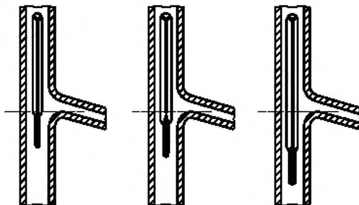
Рисунок 8 — Положение термометра в колбе для разгонки
