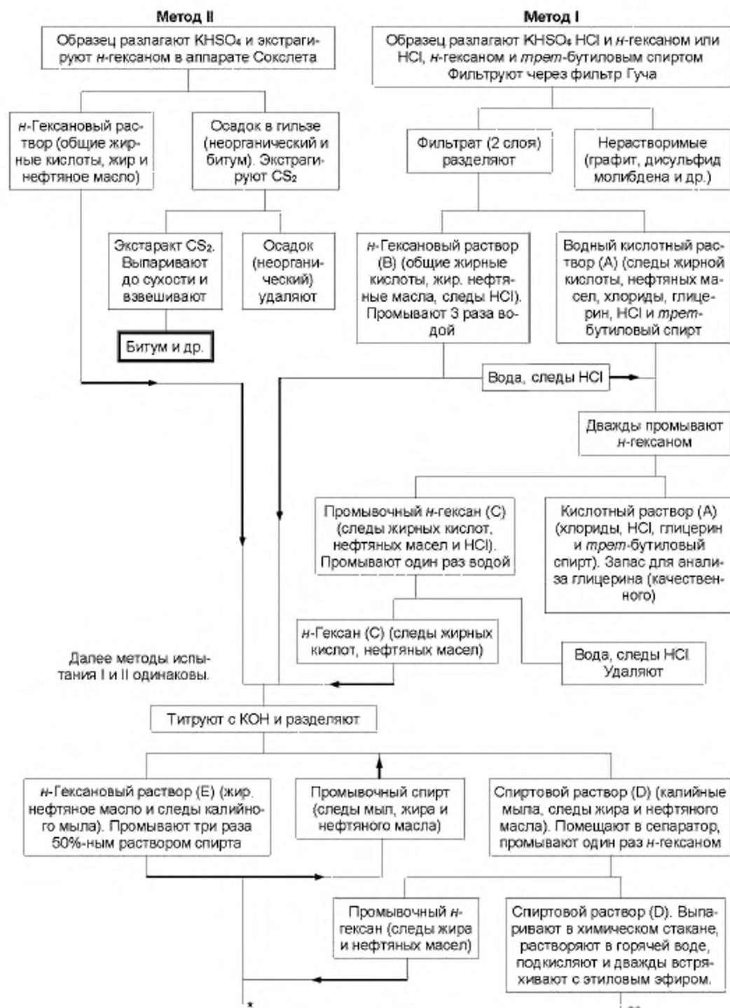
Рисунок 1 — Схема анализа пластичных смазок, лист 1
