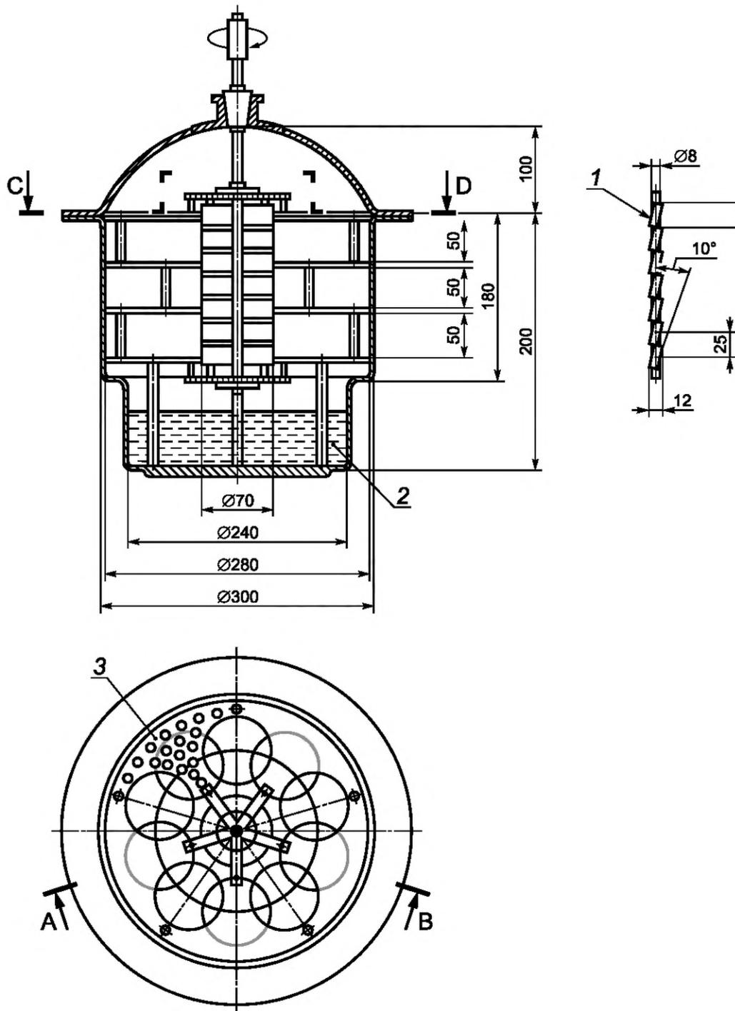
1 — вентилятор с лопастями (вид сбоку); 2 — насыщенный раствор соли с осадком на дне; 3 — пластина со 125 отверстиями диаметром 8 мм
