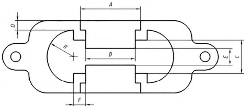
$A - (36,5 \pm 2,0)$  мм;  $B - (30,0 \pm 0,1)$  мм;  $C - (20,0 \pm 0,1)$  мм;  $D - \geq 5,5$  мм;
