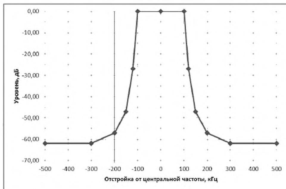
Рисунок А.2 – Маска огибающей внеполосных радиколебаний для условной ширины полосы частот 200 кГц
