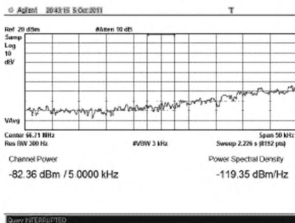
Рисунок В.23 – Плотность мощности минус 119,4 дБм/Гц на частоте  $f_{(0.150)}$
