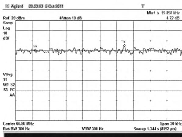
Рисунок В.18 – Форма спектра на частоте  $f_{(0)}$  в полосе сканирования 30 кГц
