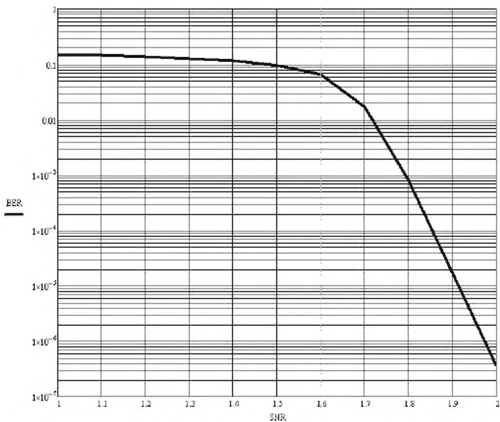
Рисунок Б.1 – График зависимости BER от ОСШ
