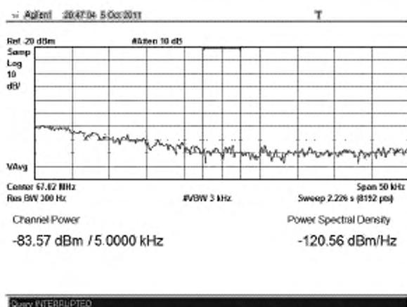
Рисунок В.32 – Плотность мощности минус 120,6 дБм/Гц на частоте  $f_{(10+150)}$
