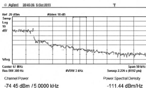
Рисунок В.29 – Плотность мощности минус 111,4 дБм/Гц на частоте  $f_{(0-140)}$
