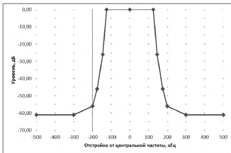
Рисунок А.3 – Маска огибающей внеполосных радиколебаний для условной ширины полосы частот 250 кГц
