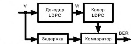
Рисунок 6 – Измерение BER до канального декодера LDPC
