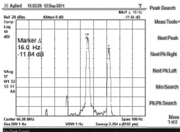
Рисунок В.5 – Agilent E440B. Результат измерений разности частот  $f_{(276)}$  и  $f_{(276)-20}$
