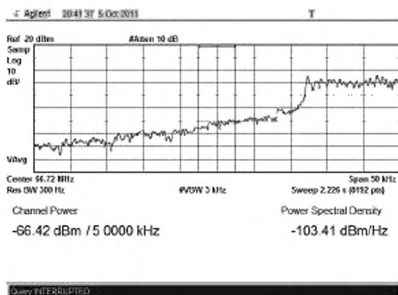
Рисунок В.26 – Плотность мощности минус 103,4 дБм/Гц на частоте  $f_{(0-135)}$
