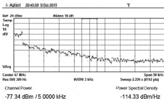
Рисунок В.30 – Плотность мощности минус 114,3 дБм/Гц на частоте  $f_{(0-145)}$
