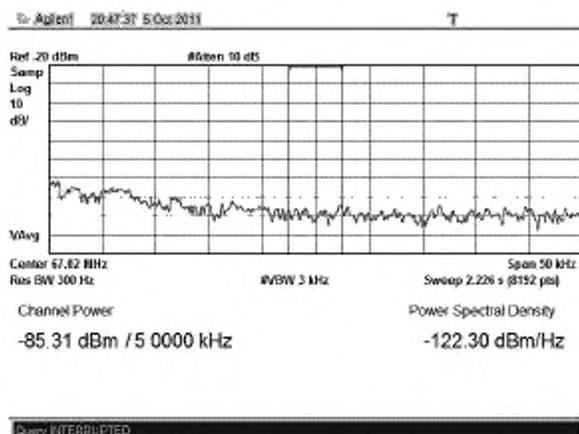
Рисунок В.33 – Плотность мощности минус 122,3 дБм/Гц на частоте  $f_{(10+160)}$
