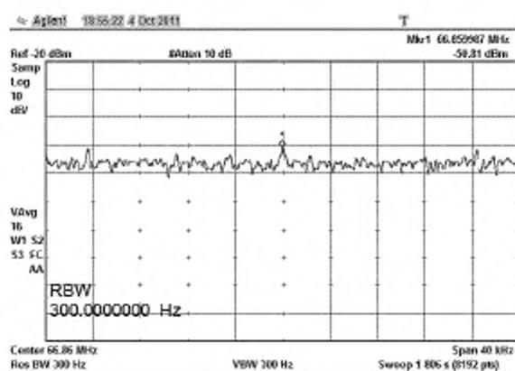
Рисунок В.36 – Полоса сканирования (Span) 40 кГц
