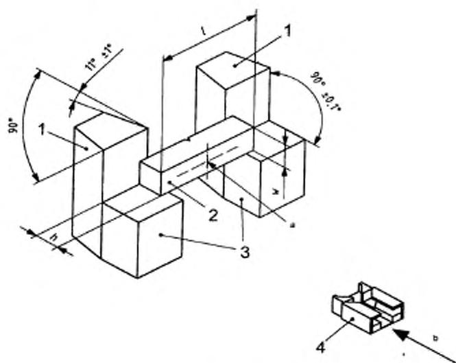
$h$  – высота испытываемого образца;  $l$  – длина испытываемого образца;
