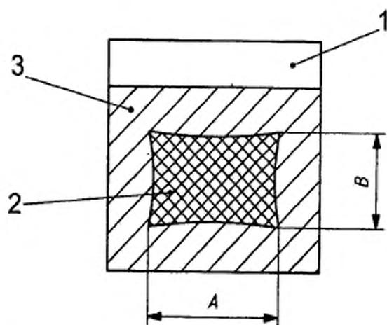
Примечание 1 - Средние размеры А и В измеряют с точностью до 0,5 мм.
