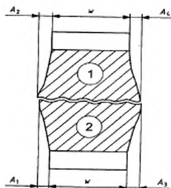
1, 2 – Половинки образца;  $w$  – исходная ширина образца;
