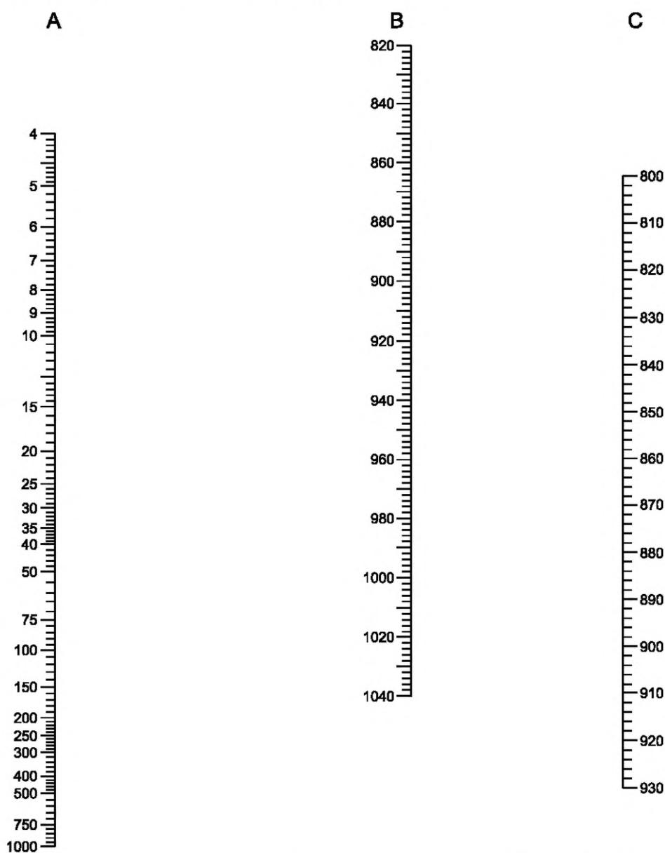
А — кинематическая вязкость при 50 °С, мм<sup>2</sup>/с; В — плотность при 15 °С, кг/м<sup>3</sup>; С — ССАИ
