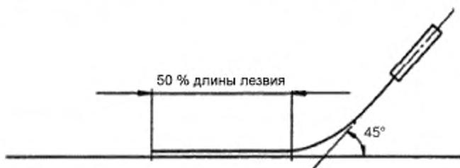
Рисунок 2 — Испытания на прочность лезвия
