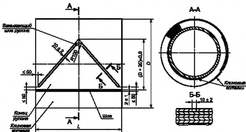
Рисунок 3 — Разделка под замыкающий шов рулонированной обечайки
