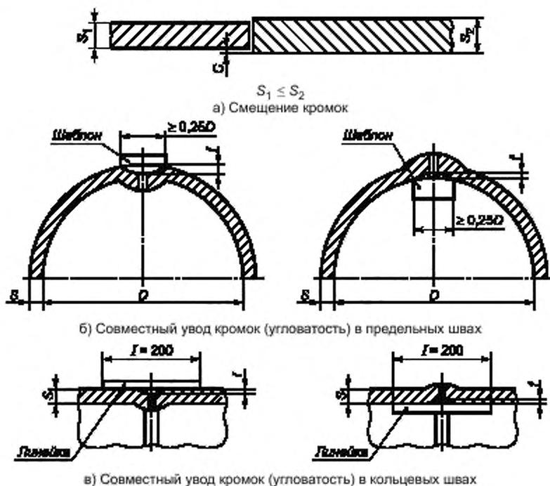
Рисунок 1 — Контроль смещения и увода кромок
