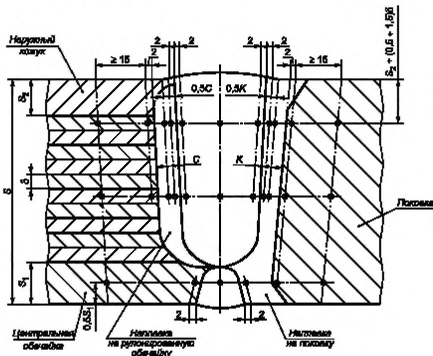
$S$  — толщина рулонированной обечайки.  $S_1$  — толщина центральной обечайки;  $S_2$  — толщина наружного кожуха;  $\delta$  — толщина рулонной стали;  $C$  — толщина наплавки на рулонированную обечайку;  $K$  — толщина наплавки на поковку
