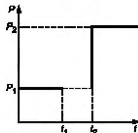
$P_1$  — давление пуска;  $P_2$  — номинальное рабочее давление в аппарате;  $t_1$  — минимальная температура воздуха, при которой допускается пуск аппарата под давлением  $P_1$ ;  $t_2$  — минимальная температура, при которой сталь и ее сварные соединения допускаются в эксплуатацию на давление  $P_2$ .
