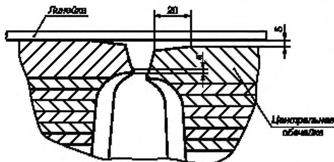
Рисунок 6 — Смещение кромок при сборке рулонированных обечаек
