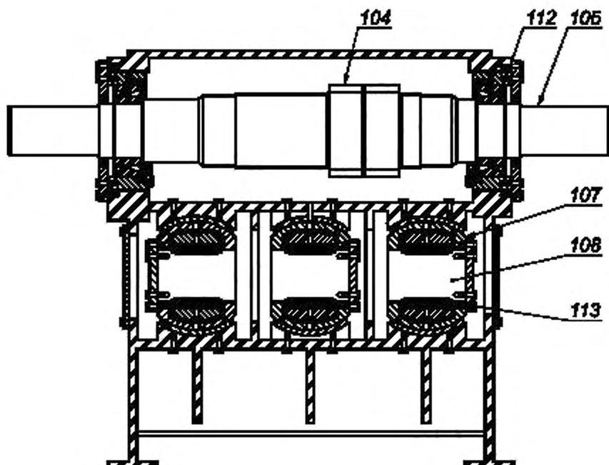
Рисунок В.3 — Поперечное сечение через вал-шестерню и крейцкопф
