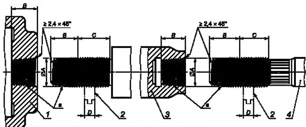
1 — ползун; 2 — конtringайка; 3 — удлинение ползуна; 4 — штоки поршня; а — 3,175 мм — шаг резьбы и конусность 1:12
