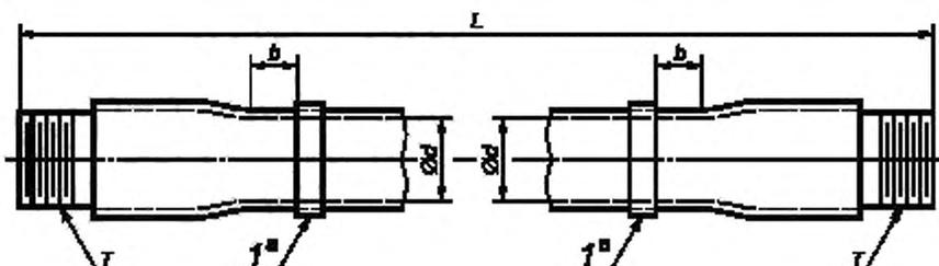
*T* — предохранительный хомут, *L* — номинальная длина, *a* — место для пометки «Место для установки присоединительного хомута»; *b* — для бурового шланга данная величина составляет от 150 до 460 мм от внутреннего края соединения; для шлангов вибратора размер составляет от 150 до 250 мм от внутреннего края соединения
