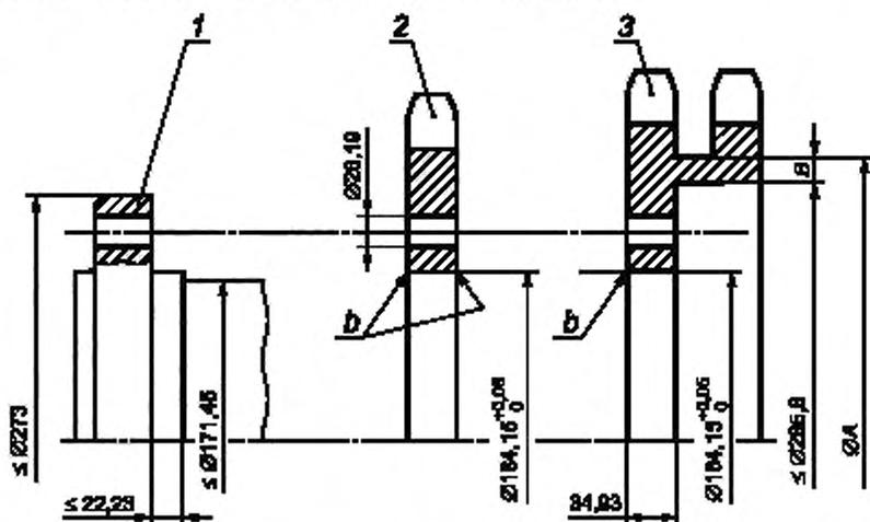
1 — ступица колеса; 2 — одиночное (единичное) колесо; 3 — двойное колесо; а — максимальный диаметр ступицы колеса, обеспечивающий зазор цепной передачи; b — фаска 2 мм 45°, с — 8 отверстий, равномерно расположенных по диаметру центральной окружности отверстий под болты
