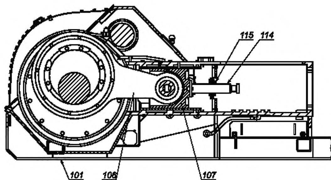
Рисунок В.1 — Поперечное сечение намоточной части
