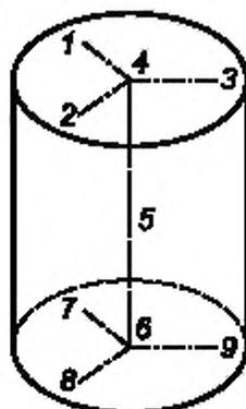
Рисунок Б.1 — Положение термодатчиков (1—9) в цилиндрических печах
