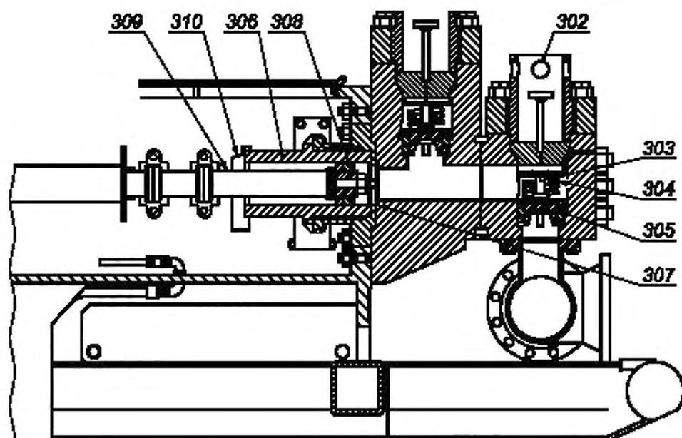
Рисунок В.5 — Нагнетательная часть триплексного бурового насоса одностороннего действия
