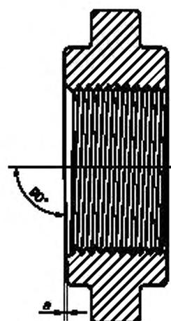
Рисунок 17 — Контргайка для удлинения крейцкофа и штока поршня
