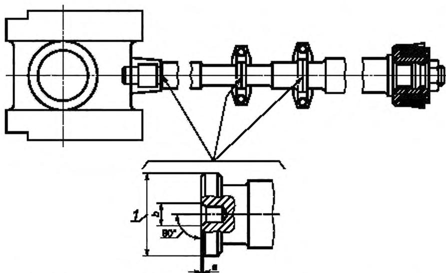
1 — диаметр торца, а — плоские поверхности контакта и посадочные диаметры на сопряженных соединениях удлинения ползуна со ступицей поршня в буровых насосах; b — допуск соосности между осевой линией посадочного диаметра и теоретической осью штока не должен превышать 0,13 мм
