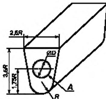
Примечание — Заштрихованная площадь А соответствует  $1/4t$  максимальной огибающей поверхности, пригодной для вырезки испытуемого образца.
