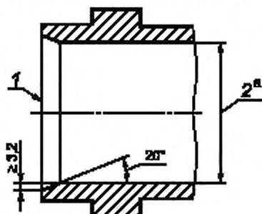
1 — входной торец плунжера, 2 — отверстие втулки;  $a$  — допуск номинального диаметра  $^{+0,13}_0$  мм
