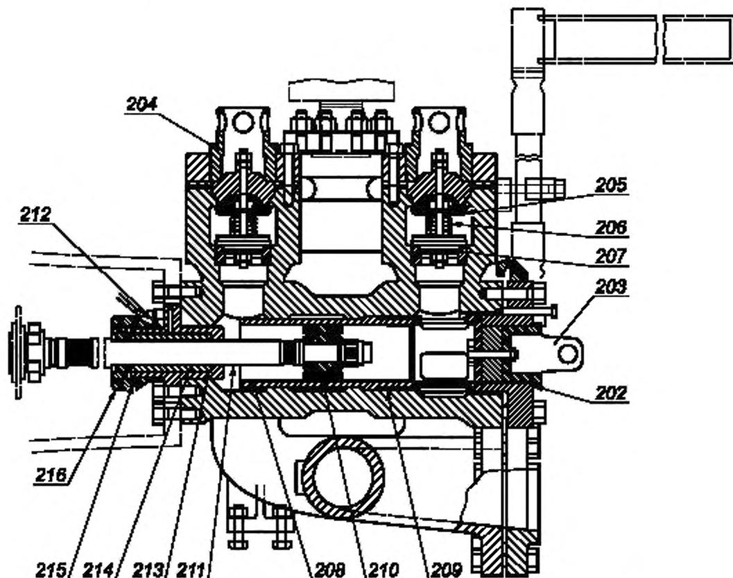
Рисунок В.4 — Нагнетательная часть дуплексного бурового насоса двукратного действия
