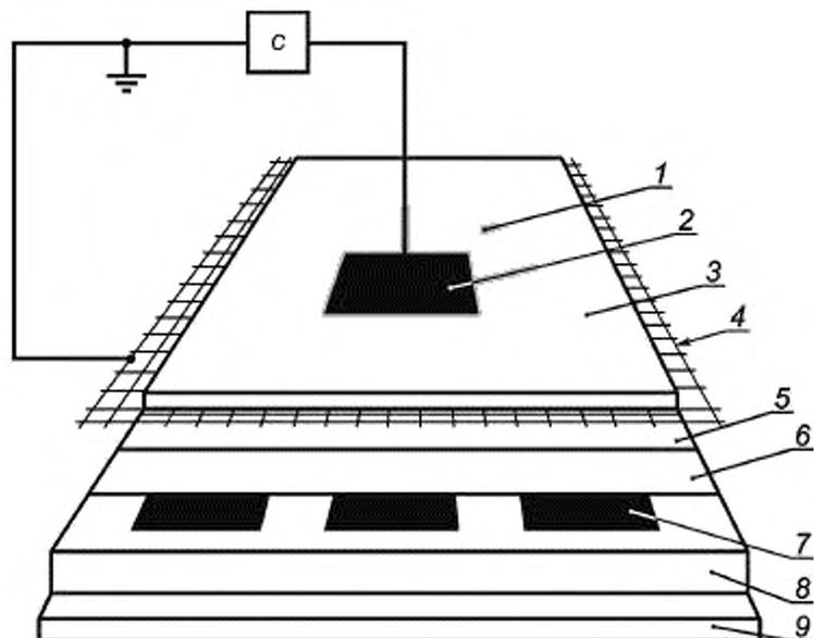
С — схема, приведенная на рисунке 4 приложения 1 настоящего стандарта; 1 — раствор соли; 2 — металлическая фольга; 3 — покрытие на пол; 4 — сетка; 5 — дополнительный слой (если предусмотрен); 6 — дополнительная электрическая изоляция (если предусмотрена); 7 — нагревательный блок; 8 — термоизоляция; 9 — фанерное основание
