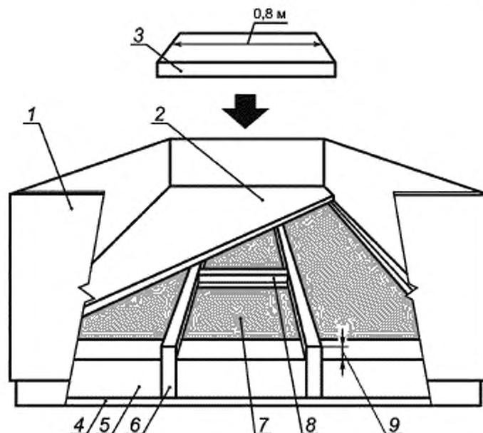
1 — деревянная доска; 2 — пол; 3 — кусок изоляции; 4 — опора для термоизоляции; 5 — термоизоляция; 6 — деревянный каркас 50 × 200 мм; 7 — нагревательный блок; 8 — поперечный элемент; 9 — воздушный зазор
