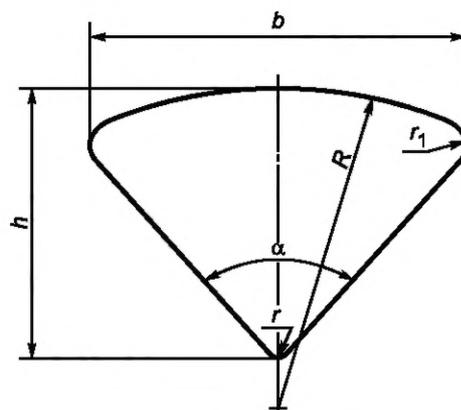
$r_1 \geq 0,5$  мм — радиус закругления
