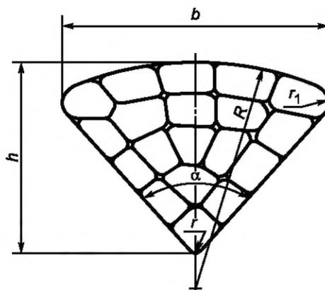
$r_1$  — радиус закругления, равный  $\frac{1}{2}$  диаметра проволоки
