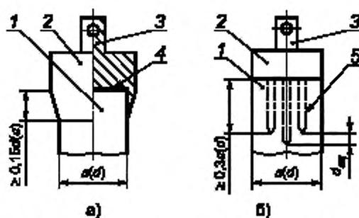
1 — образец; 2 — захват; 3 — конечный элемент шарнира Гука; 4 — клей; 5 — анкер
