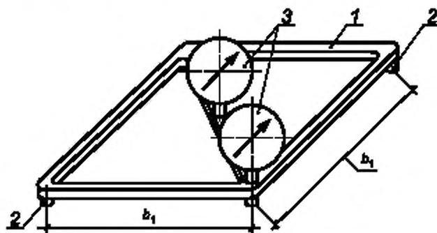
$b_1$  — база прибора; 1 — корпус (рамка); 2 — опора; 3 — индикатор
