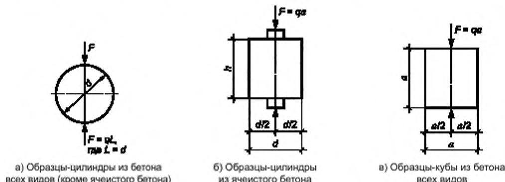
Рисунок 3 — Схемы испытания на растяжение при раскалывании (Лист 1)
