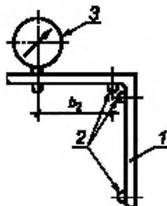
$b_2$  — база прибора; 1 — корпус (угольник), 2 — опора; 3 — индикатор
