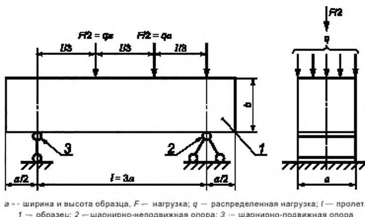
Рисунок 2 — Схема испытания на растяжение при изгибе
