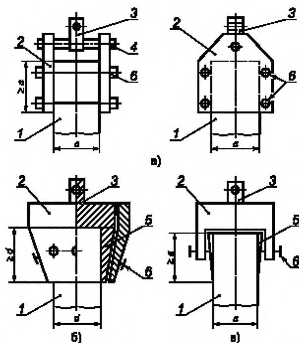
1 — образец; 2 — захват; 3 — конечный элемент шарнира Гука; 4 — ось; 5 — цанга; 6 — стягивающие винты
