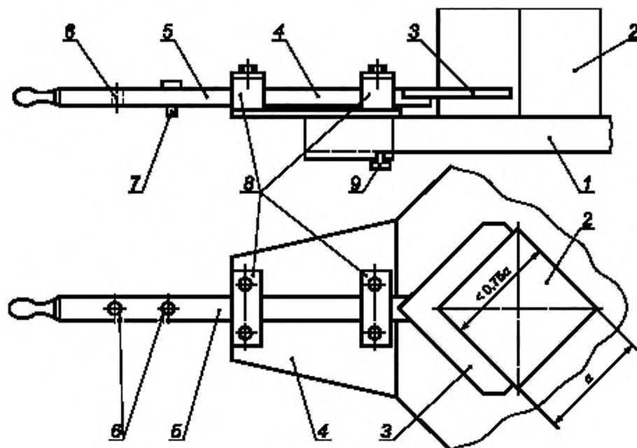
1 — плита пресса; 2 — образец; 3 — угольник; 4 — основание приспособления; 5 — шток;
