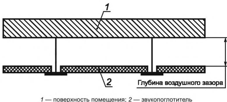
Рисунок 2 — Схема размещения образцов материала при проведении испытаний
