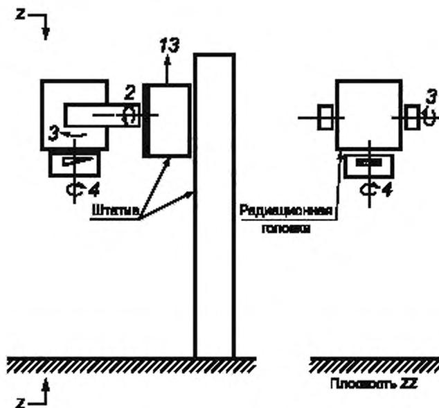
2 — наклон РАДИАЦИОННОЙ ГОЛОВКИ, ось 2; 3 — крен РАДИАЦИОННОЙ ГОЛОВКИ, ось 3;
