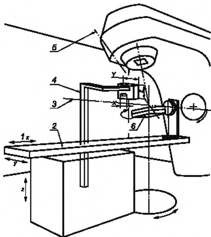
1 —  $x$ ,  $y$ ,  $z$  — микрометрическая настройка опорного указателя; 2 — дека СТОЛА для ПАЦИЕНТА; 3 — настенный источник света; 4 — держатель центриатора, укрепленный на полу, позволяющий поворачивать ШТАТИВ на  $360^\circ$  и СТОЛ для ПАЦИЕНТА на меньшие углы, 5 — потолочный источник света, 6 — блок из моделирующего материала и пленка
