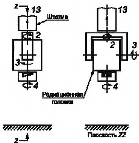
2 — наклон РАДИАЦИОННОЙ ГОЛОВКИ, ось 2; 3 — крен РАДИАЦИОННОЙ ГОЛОВКИ, ось 3;
