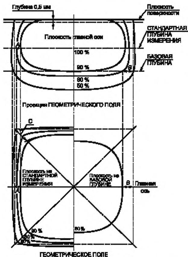
Рисунок 6 — Примеры диаграммы равномерности ЭЛЕКТРОННОГО ПОЛЯ
