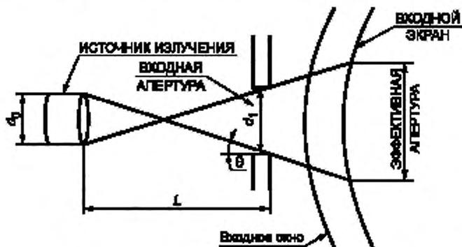
Рисунок 1 — Схема расположения ИСТОЧНИКА ИЗЛУЧЕНИЯ и ВХОДНОЙ АПЕРТУРЫ
