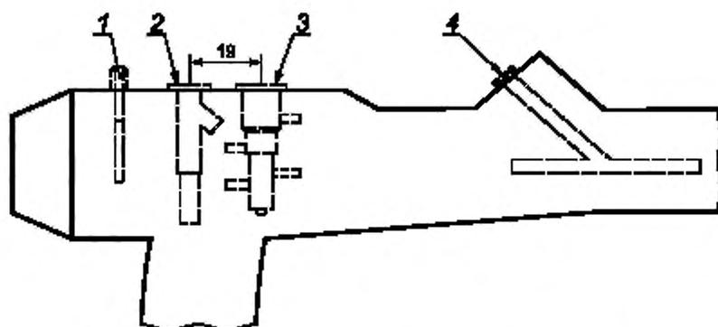
1 — входной порт элеваторного канала; 2 — клапан отсоса; 3 — клапан воздуха/воды; 4 — биосийный порт
