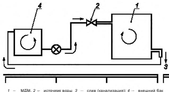
Примечание — Вследствие рекомендаций изготовителя, внешние устройства должны быть врезаны между источником водоснабжения и МДМ (умячителем, и т. д.).
