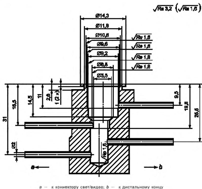
Примечание — Допуски  $^{+0,1}_0$  мм — для отверстий,  $^0_{-0,1}$  мм — для валов и  $\pm 0,1$  мм — для остальных размеров.
