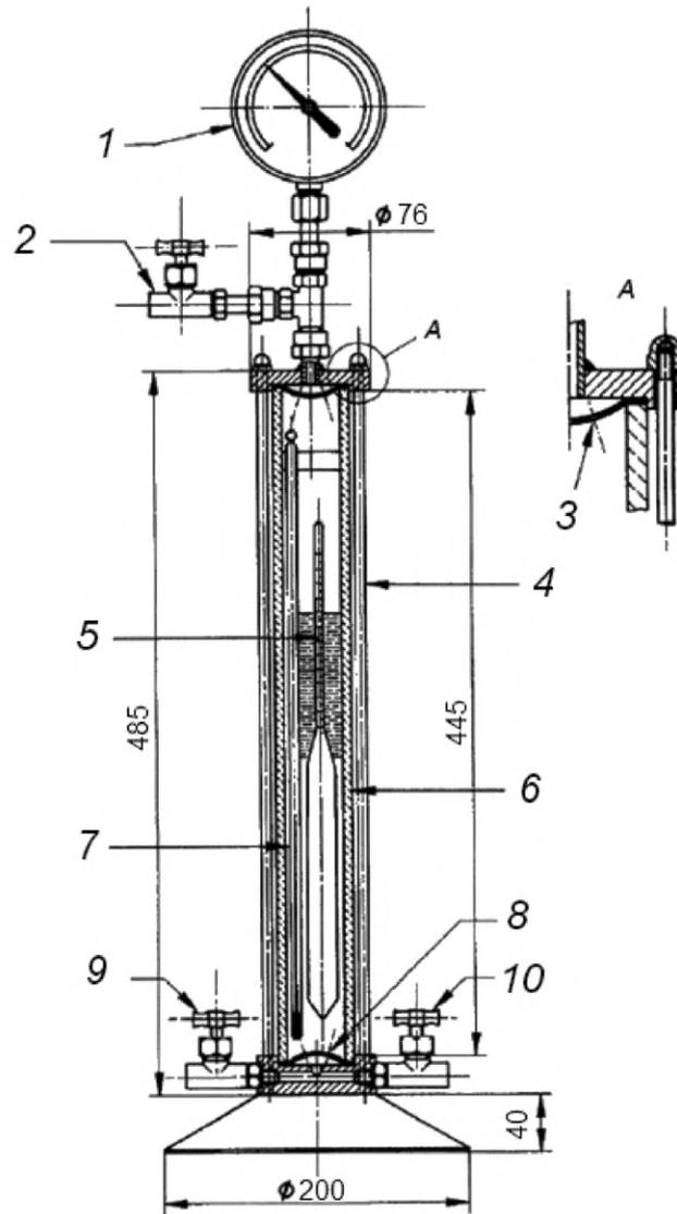
1 — манометр; 2 — вентиляционный вентиль диаметром 6 мм (или эквивалентный); 3 — отверстия; 4 — шесть штырей диаметром 6 мм каждый; 5 — ареометр; 6 — пластмассовая или стеклянная трубка наружным диаметром 51 мм, толщиной стенки 6,5 мм; 7 — термометр; 8 — резиновая прокладка (с отверстиями 3 — см. А); 9 — впускной игольчатый вентиль диаметром 6 мм; 10 — выпускной игольчатый вентиль диаметром 6 мм
