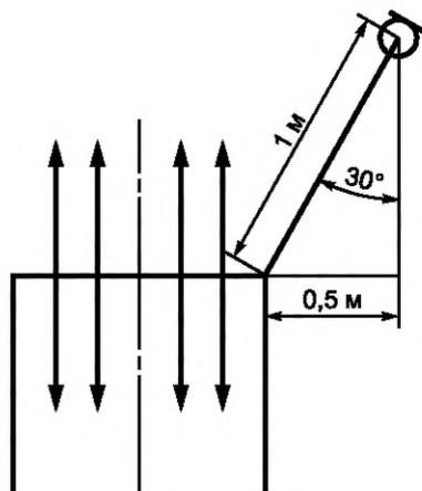
Рисунок 2 — Измерительные точки у всасывающего или выхлопного патрубка
