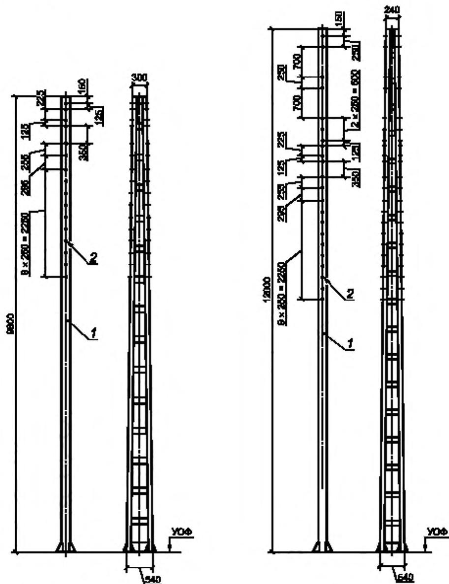
1 — стойка; 2 — отверстия для установки закладных изделий
