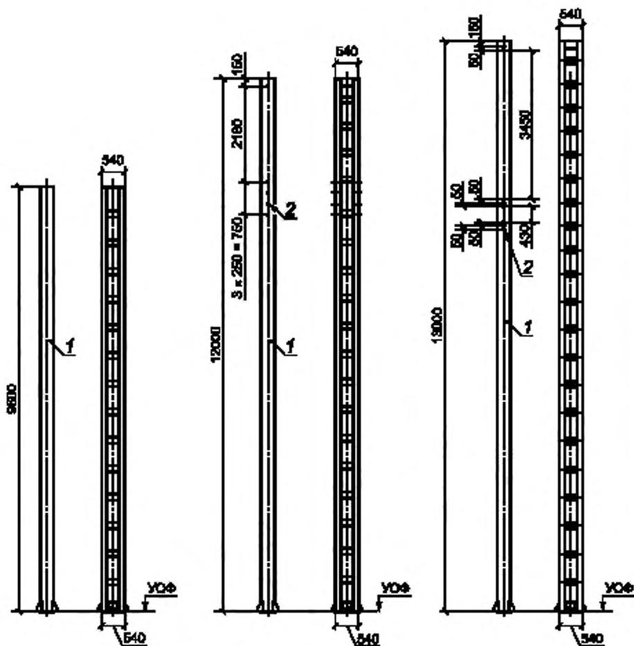
1 — стойка; 2 — отверстия для установки закладных изделий
