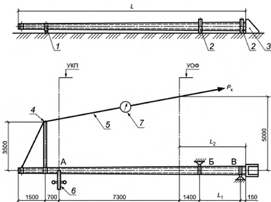
1 — шарнирно-скользящая опора; 2 — шарнирно-неподвижные опоры; 3 — упор в торце; 4 — горизонтальная консоль; 5 — трос; 6 — измерительная рейка, установленная на неподвижное основание; 7 — динамометр, А, Б и В — места замера перемещений,  $L$  — общая длина стойки;  $L_1$  — расстояние между шарнирно-неподвижными опорами А и Б (см. таблицу В.1);  $L_2$  — расстояние от нижней комлы стойки до УОФ (см. таблицу В.1);  $P_k$  — усилие натяжения троса при испытании, равное расчетной нагрузке
