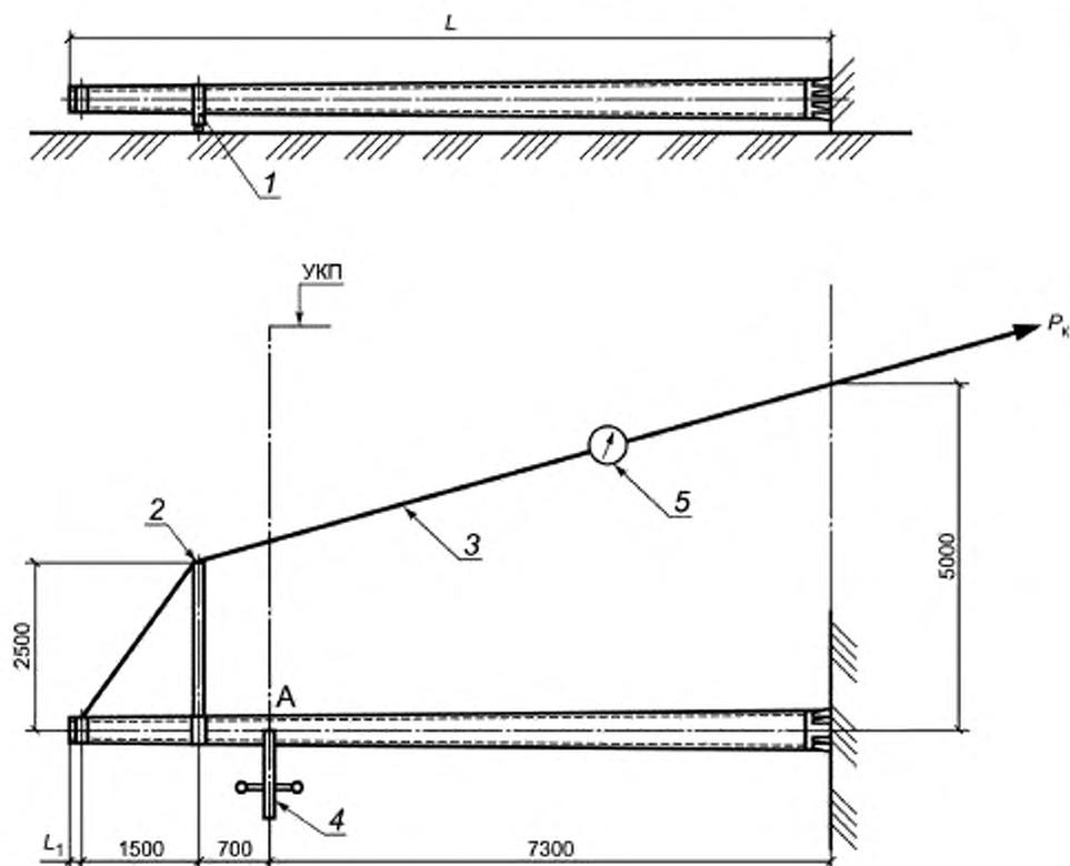
1 — шарнирно-скользящая опора; 2 — горизонтальная консоль; 3 — трос; 4 — измерительная рейка, установленная на неподвижное основание; 5 — динамометр,  $A$  — место замера перемещений;  $L$  — общая длина стойки,  $L_1$  — расстояние от вершины стойки до оттяжки горизонтальной консоли (см. таблицу В.3);  $P_k$  — усилие натяжения троса при испытании, равное расчетной нагрузке
