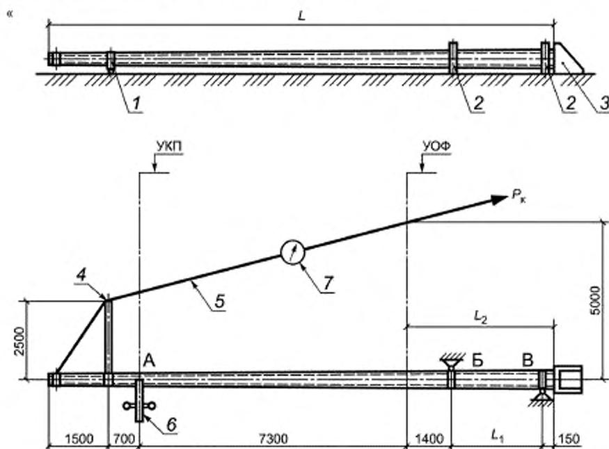
1 — шарнирно-скользящая опора, 2 — шарнирно-неподвижные опоры; 3 — упор в торце, 4 — горизонтальная консоль, 5 — трос; 6 — измерительная рейка, установленная на неподвижном основании; 7 — динамометр; А, Б и В — места замера перемещений; L — общая длина стойки;  $L_1$  — расстояние между шарнирно-неподвижными опорами А и Б (см. таблицу В.1);  $L_2$  — расстояние от нижней комлы стойки до УОФ (см. таблицу В.1);  $P_k$  — усилие натяжения троса при испытании, равное расчетной нагрузке
