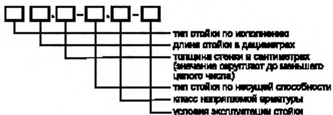
Рисунок Б.1 — Пример условного обозначения стоек железобетонных
