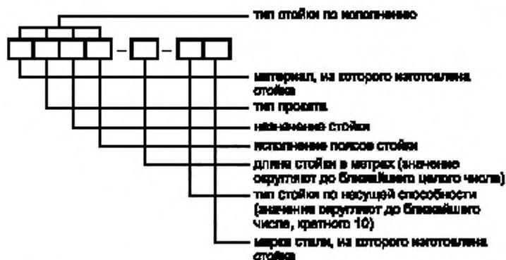
Рисунок Б.2 — Пример условного обозначения стоек металлических
