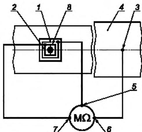
1 — изолирующий элемент; 2 — стальная шайба; 3 — выпуск провода диагностики; 4 — стойка;
