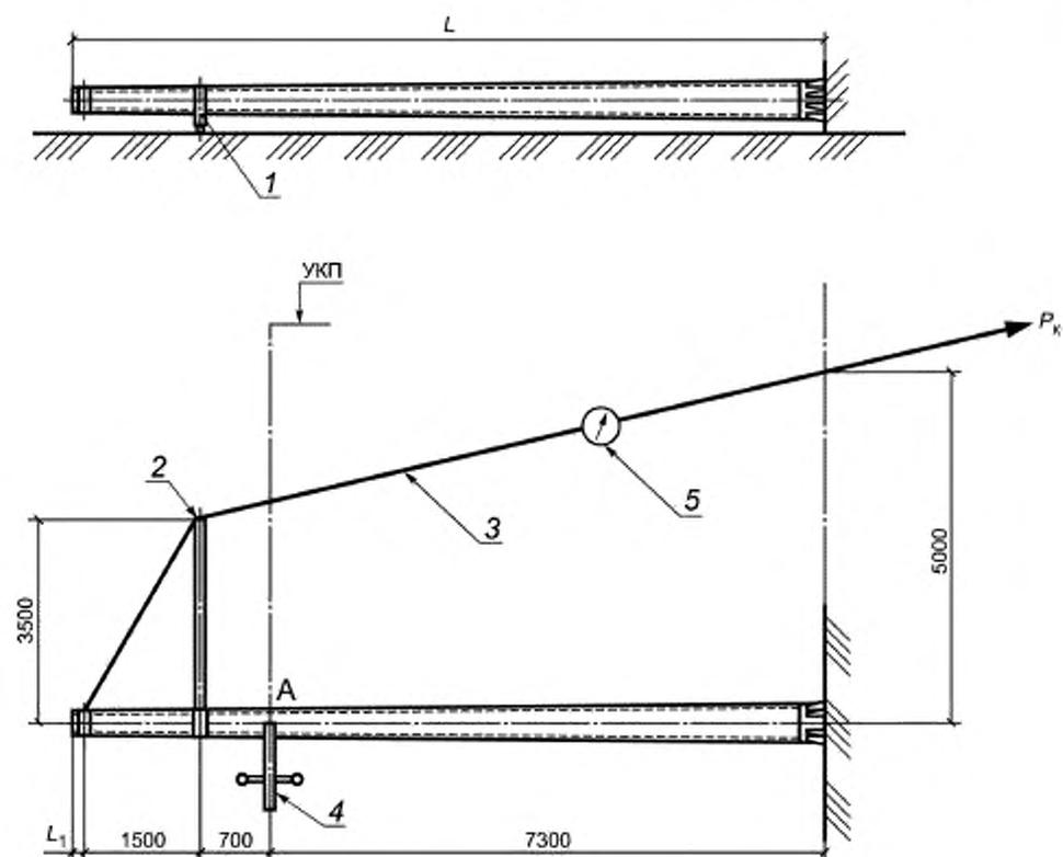
1 — шарнирно-скользящая опора; 2 — горизонтальная консоль; 3 — трос; 4 — измерительная рейка, установленная на неподвижное основание; 5 — динамометр, А — место замера перемещений;  $L$  — общая длина стойки,  $L_1$  — расстояние от вершины стойки до оттяжки горизонтальной консоли (см. таблицу В.3);  $P_k$  — усилие натяжения троса при испытании, равное расчетной нагрузке
