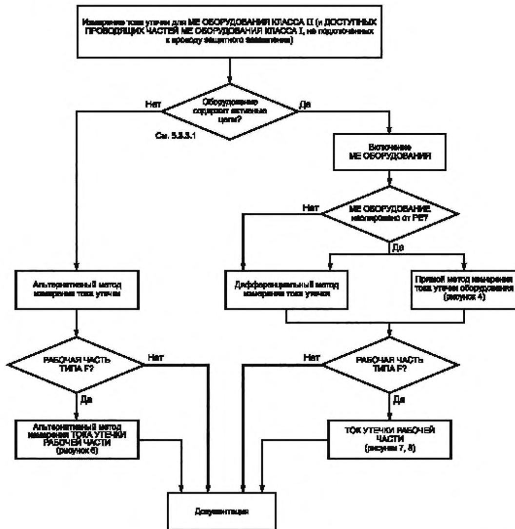
Рисунок В.3 — Измерение ТОКА УТЕЧКИ (МЕ ОБОРУДОВАНИЕ КЛАССА II и ДОСТУПНЫЕ ПРОВОДЯЩИЕ ЧАСТИ ОБОРУДОВАНИЯ КЛАССА I, не подключенных к проводу защитного заземления)
