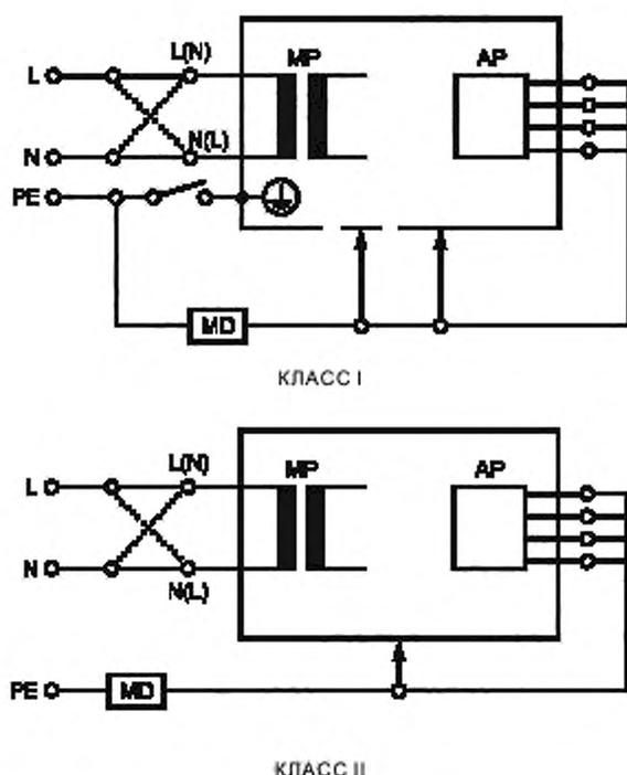
Испытуемое устройство должно быть изолировано от защитного заземления.
