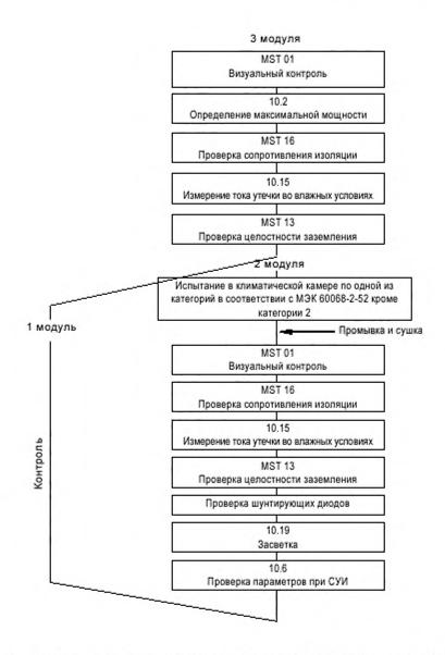
П р и м е ч а н и е 1 — Измерения 10.2 и 10.15 проводят в соответствии с МЭК 61646. Измерения MST 13 и MST 16 проводят в соответствии с МЭК 61730-2.
