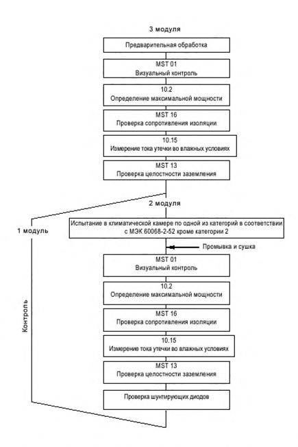
П р и м е ч а н и è 1 — Предварительную обработку результатов измерения по 10.2 и 10.15 проводят в соответствии с МЭК 61215. Измерения MST 13 и MST 16 проводят в соответствии с МЭК 1730-2.
