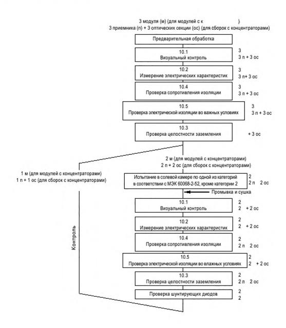
П р и м е ч а н и е 1 — Измерения 10.2, 10.3, 10.4 и 10.5 проводят в соответствии с МЭК 62108. П р и м е ч а н и е 2 — Измерения на контрольном образце проводят одновременно с измерениями на испытуемых образцах для проверки влияния солевого тумана на их характеристики испытуемых образцах.
