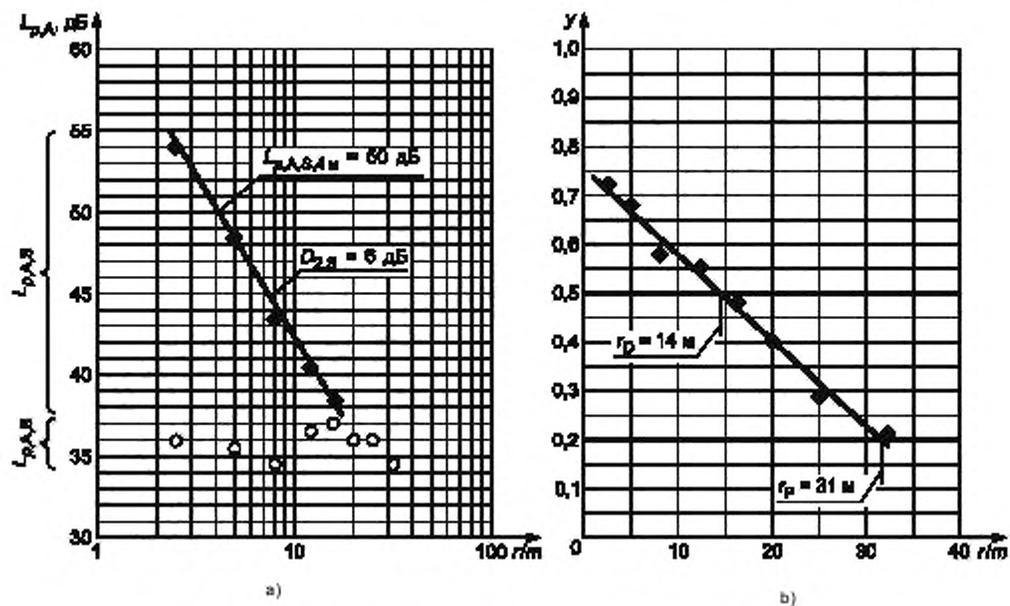
$L_{pA}$  — уровень звука;  $r$  — расстояние до говорящего;  $D_{2,S}$  — скорость пространственного спада речи;  $L_{pA,0}$  — уровень звука фонового шума;  $L_{pA,S}$  — уровень звука речи;  $L_{pA,3,4m}$  — уровень звука речи на расстоянии 4 м от источника
