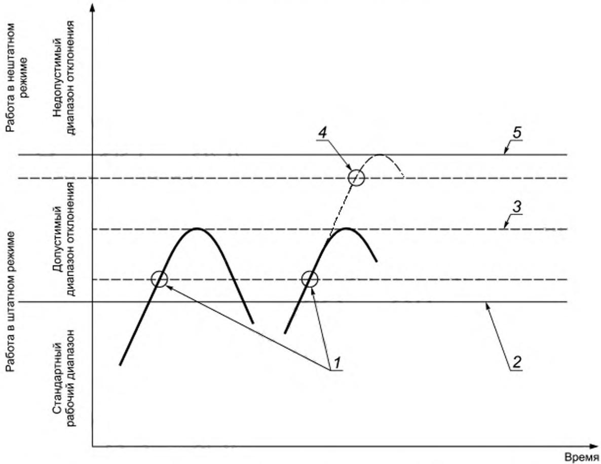
1 — заданное давление основного клапана сброса давления; 2 — максимально допустимое рабочее давление (МДРД);
