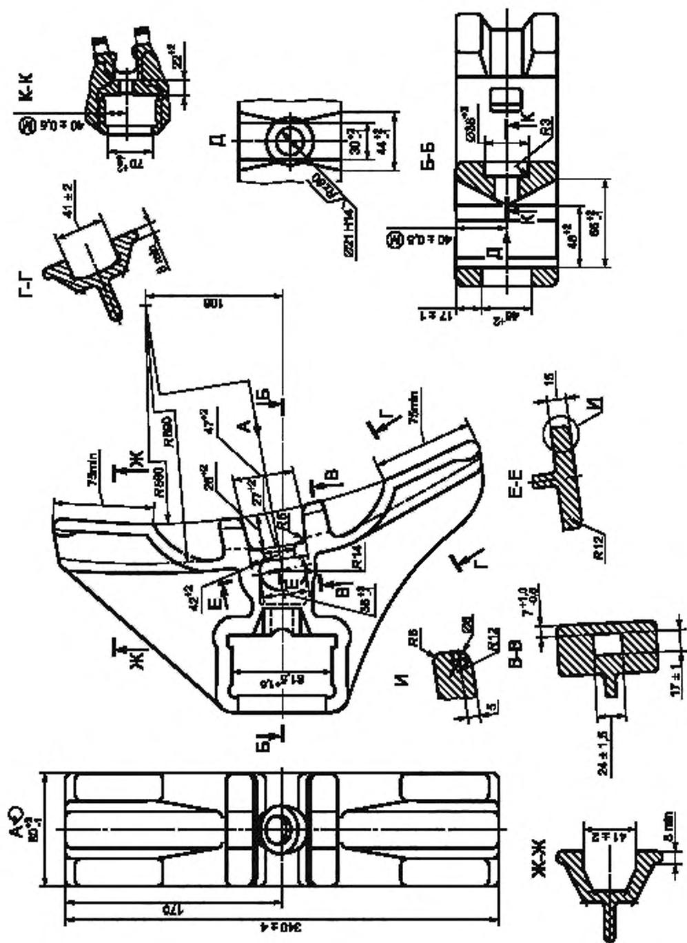
Рисунок 2 — Башмак — тип 1/Исполнение 1
