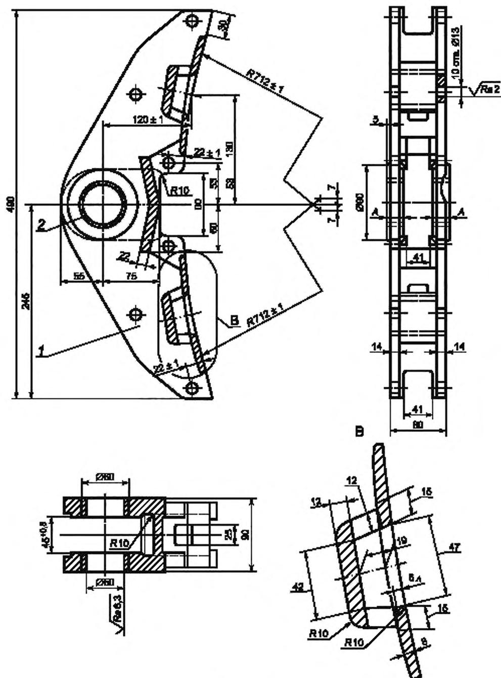
Рисунок 9 — Башмак секционный типа 4
