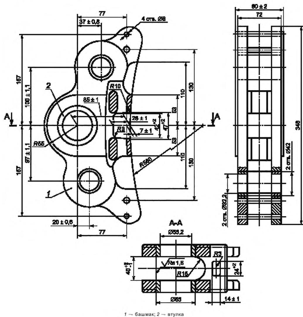
Рисунок 5 — Башмак типа 2 — Исполнение 1
