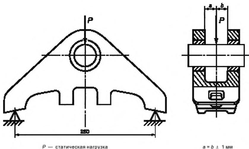
Рисунок В.1 — Схема испытания башмака статической нагрузкой
