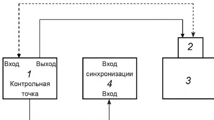
1 — электронный блок дефектоскопа; 2 — преобразователь; 3 — калибровочный образец;
