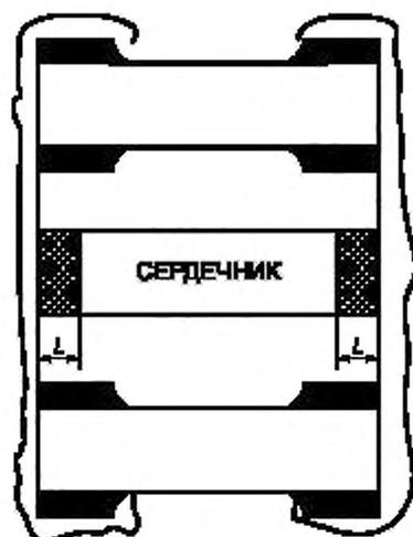
L — зазор между сердечником и металлическими поверхностями
