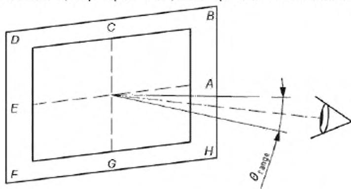
Поставщик должен точно определить максимальную длину угла отклонения  $\Theta_{range}$ . Угол азимута  $\Phi$  от  $0^\circ$  до  $360^\circ$ .
