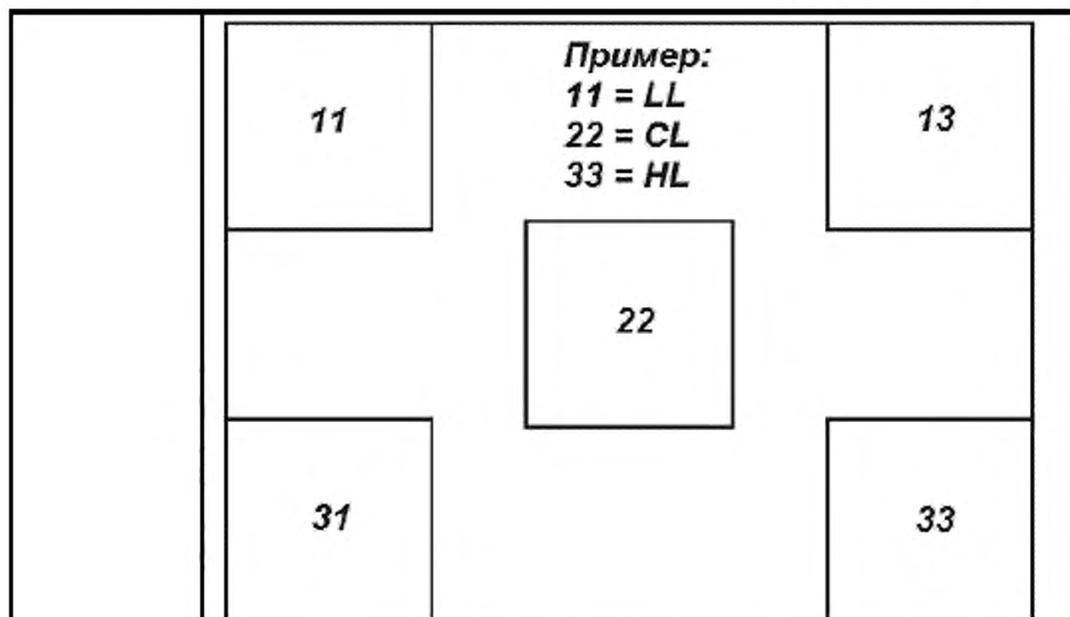
Рисунок 11 – Исходные расположения на анизотропном излучающем плоскопанельном ЖК-дисплее с примером расположения точек снятия значений (преобладает искусственная информация)
