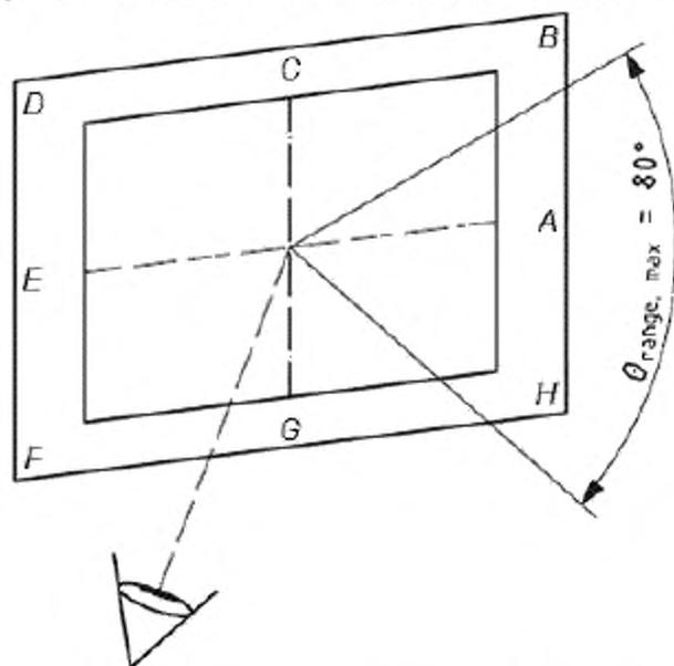
В зависимости от приложения угол отклонения  $\Theta$  может превышать  $40^\circ$ , вне конуса наблюдения с максимальной длиной угла отклонения  $\Theta_{range, max}$ , равной  $80^\circ$ . Поставщик должен точно описать максимальную длину угла отклонения  $\Theta_{range, max}$ .
