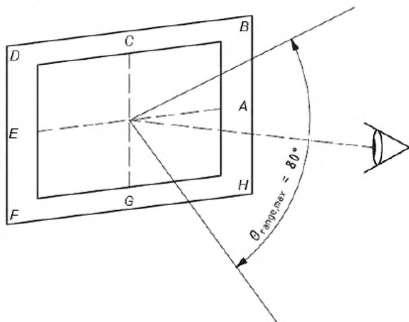
Для данной схемы определения соответствия рассматривают максимальную длину отклонения угла  $\Theta_{\text{range, max}} = 90^\circ$ , если иное не указано поставщиком. В связи с этим максимальный  $\Theta$  равен  $40^\circ$ . Угол азимута  $\Phi$  равен от  $0^\circ$  до  $360^\circ$ .
