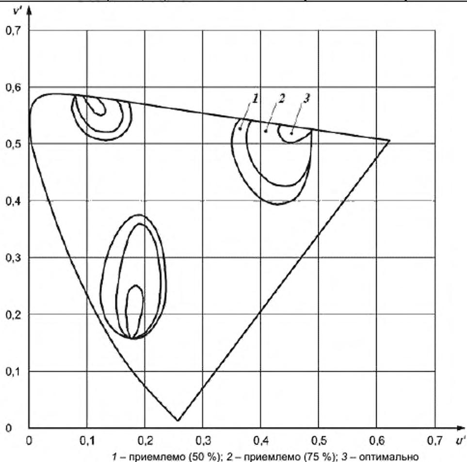
Рисунок 16 – Оптимальный и приемлемый цветовые диапазоны. Плазменные дисплеи
