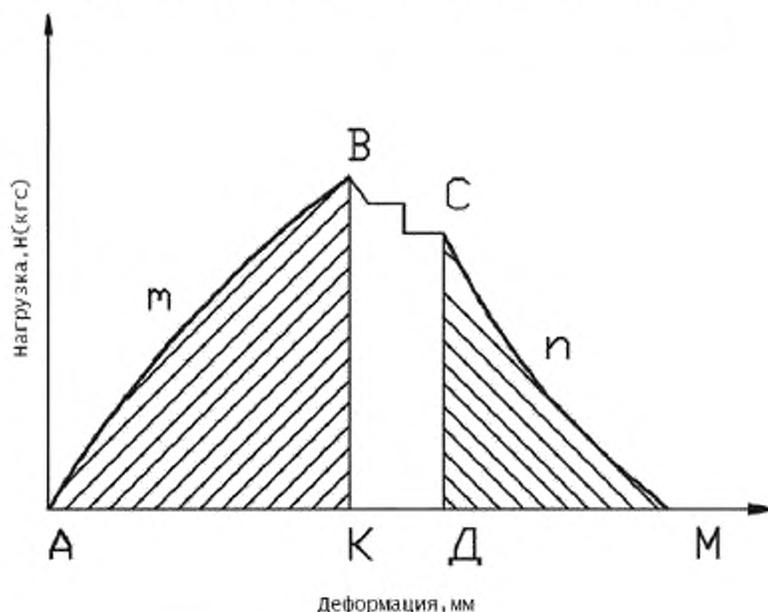
Рисунок Д.2 – Зависимость деформации образца от нагрузки
