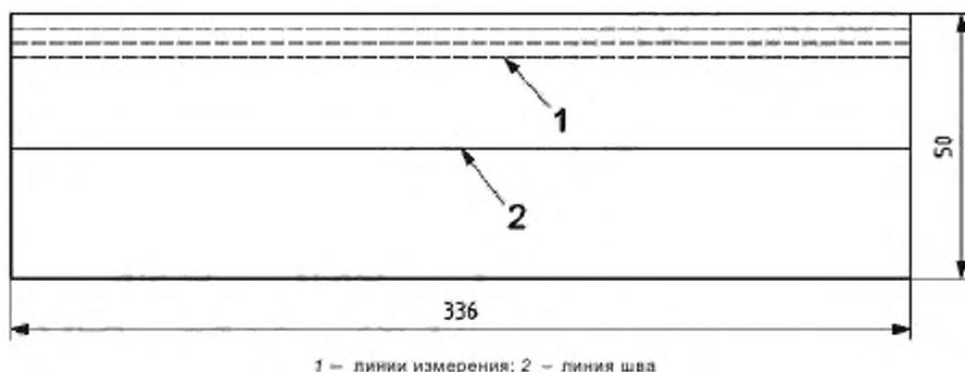
Рисунок А.2 — Область измерений эталона шва
