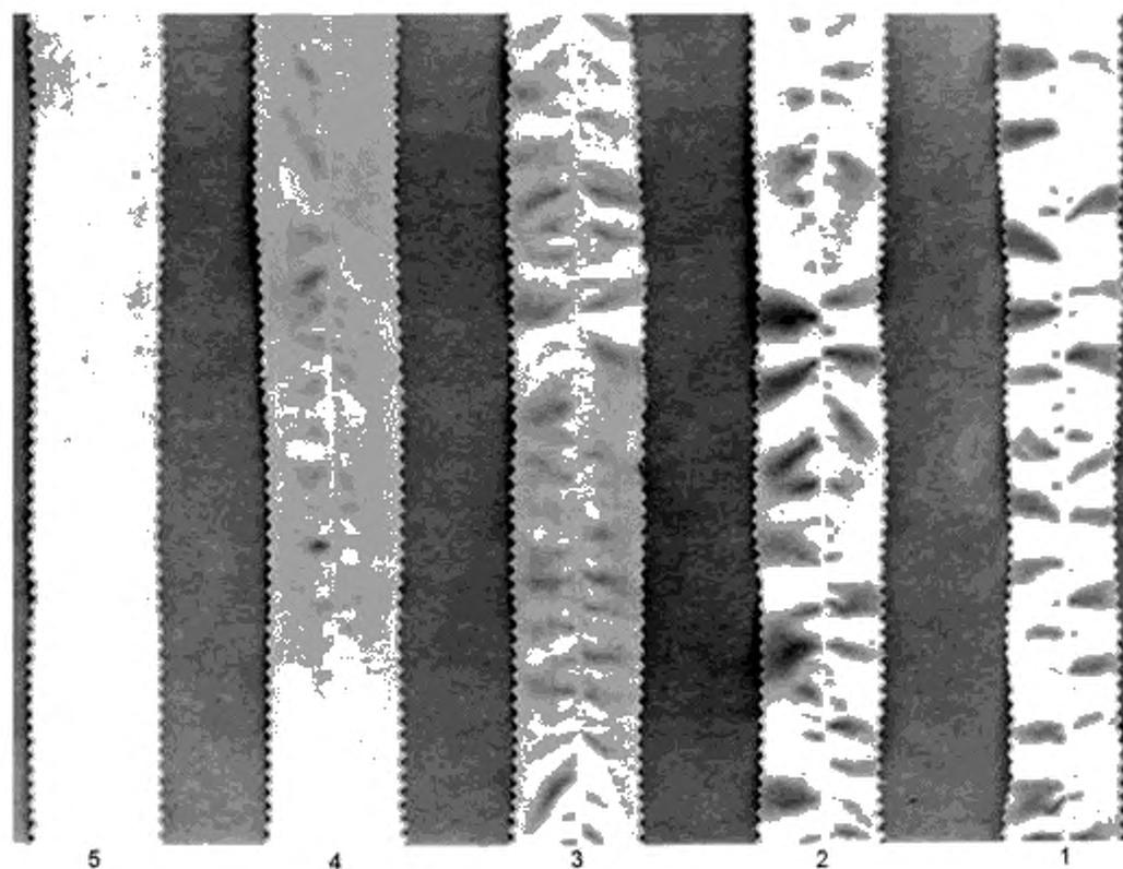
Рисунок 2 — Фотография сравнительной шкалы для одинарных швов
