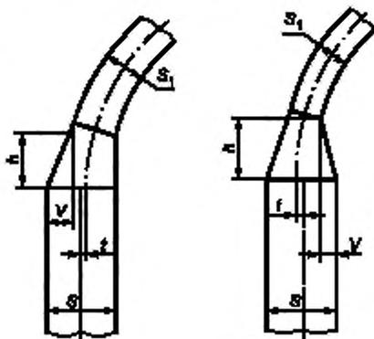
Рисунок 2 — Узел соединения днища с обечайкой
