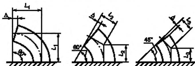
Рисунок 13 — Схема определения размеров  $L_1$ ,  $L_2$ ,  $L_3$  отводов в зависимости от углагиба
