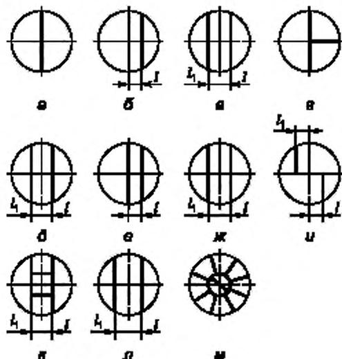
Рисунок 1 — Расположение сварных швов заготовок выпуклых днищ
