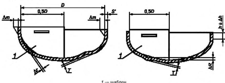
Рисунок 6 — Отклонение размеров и формы эллиптического днща
