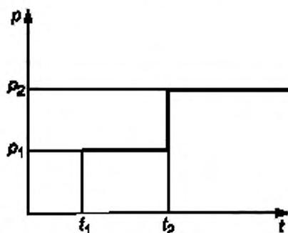
$p_1$  — давление пуска;  $p_2$  — рабочее давление.  $t_1$  — наименьшая температура воздуха, при которой допускается пуск сосуда под давлением  $p_1$ ;  $t_2$  — минимальная температура, при которой сталь и ее сварные соединения допускаются для работы под давлением в соответствии с требованиями приложений А—Д.
