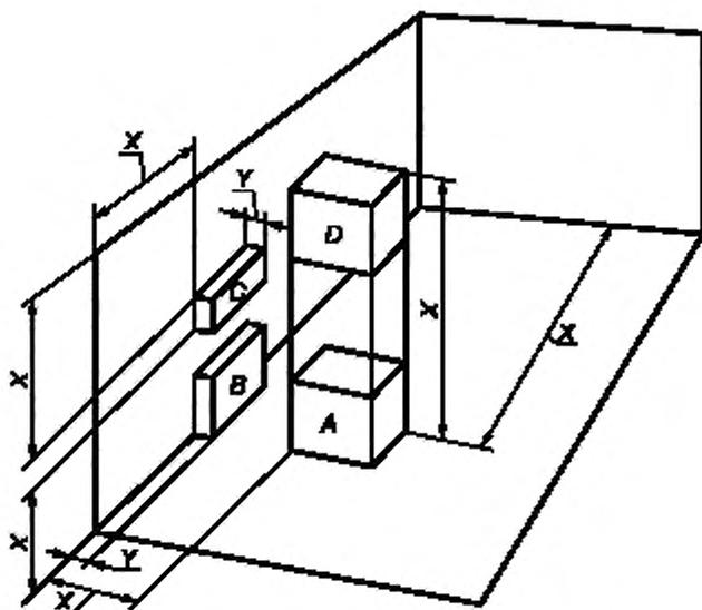
А — оборудование вдали от стены; В — оборудование, монтируемое аблизь пола или потолка и на стене или в стене, С — оборудование, монтируемое на стене или в стене; D — оборудование, подвешенное к потолку или закрепленное на нем или смонтированное в потолок; X — минимальное расстояние от соседних поверхностей помещения, равное 1,5 м, если иначе не установлено изготовителем; Y — рекомендованное изготовителем минимальное выступание оборудования в помещение
