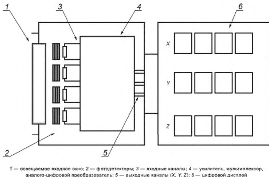
Рисунок 1 — Схематическое изображение колориметра
