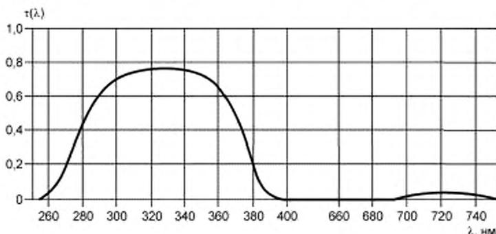
Рисунок 3 — Спектральный коэффициент пропускания  $\tau(\lambda)$  корректирующего УФ-фильтра
