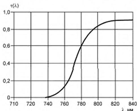
Рисунок 4 — Спектральный коэффициент пропускания  $\tau(\lambda)$  корректирующего ИК-фильтра
