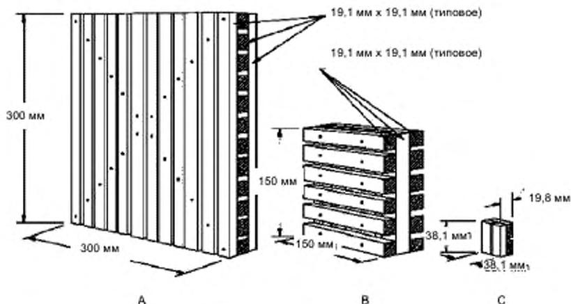
Рисунок А.2 — Конструкция для испытания на горючесть
