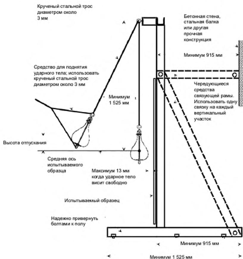
Рисунок 5 — Конструкция № 1 для испытания на удар
