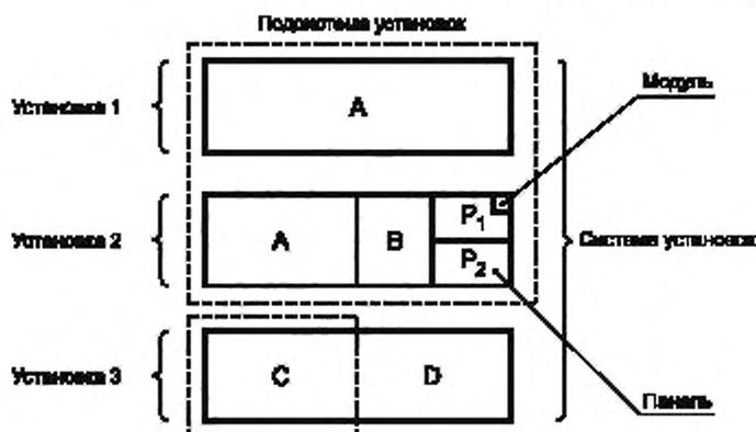
Рисунок А.1 — Элементы систем установок
