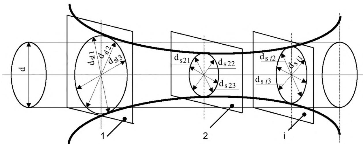
Рисунок А.1 – Единичные плоскости 1, 2 и  $i$  и единичные диаметры отверстия**А.1.2 Средний диаметр отверстия  $d_m$**
