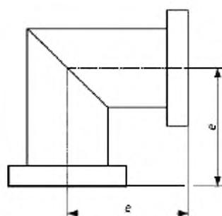
$e$  — размер от оси до поверхности фланца
