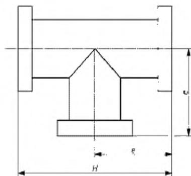
$e$  — размер от оси до поверхности фланца,
